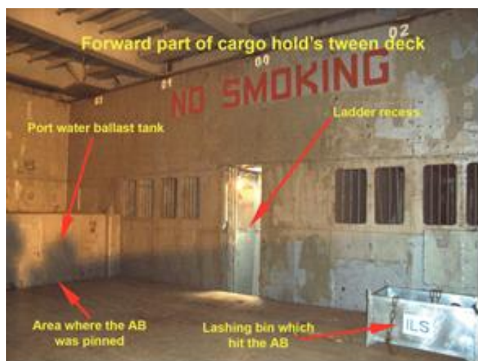
Figura 1.5: Entrepuente del Thor Gitta en donde falleció el AB Fuente: towmasters.files.wordpress.com.
