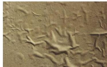
Figura 11. Ejemplo "Arrugados-levantados". [13]
