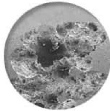
*Figura 6. Ejemplo de corrosión por picaduras. (Pitting Corrosion).* Fuente: [13]
