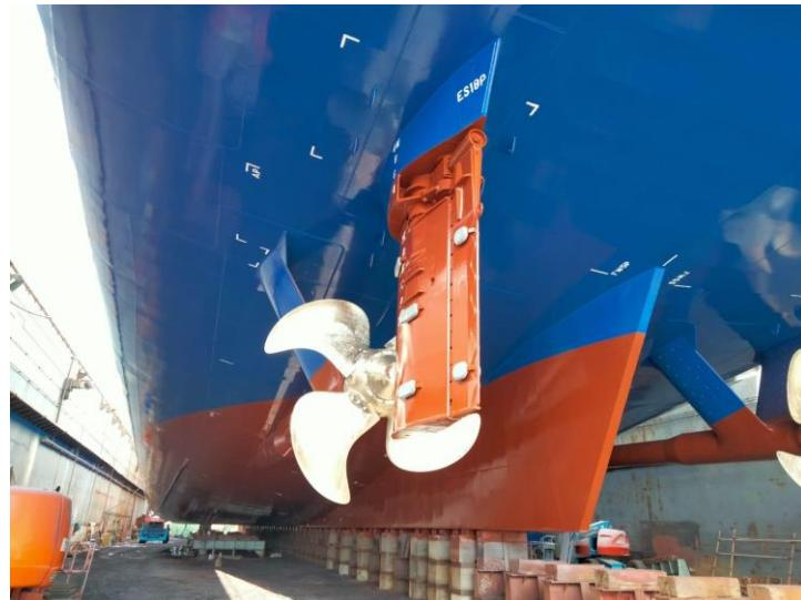
Figura 33. Palas del timón. Fuente: Elaboración propia.
