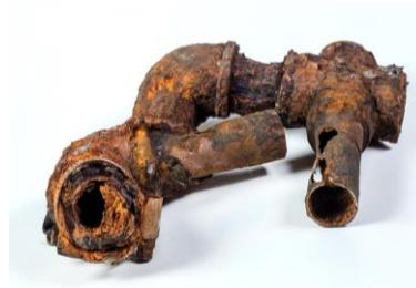
Figura 12. Tubería con ondulaciones y huecos causados por corrosión-erosión. Fuente: [23]
