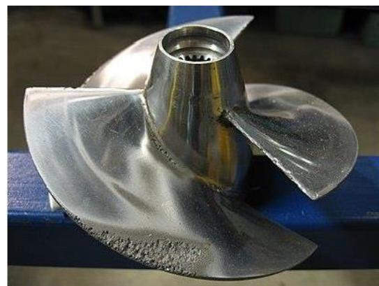
*Figura 15. Efectos de la corrosión por cavitación. Fuente: [28]*
