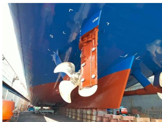
*Figura 21. Pintura antifouling aplicada en la obra viva del buque. Fuente:
