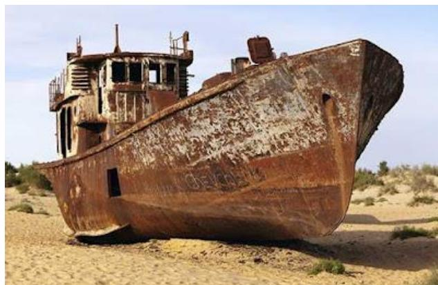
*Figura 5. Ejemplo de corrosión uniforme. Fuente: [11]*
