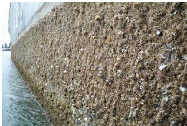
*Figura 20. Biofouling en el casco de un buque. Fuente: [52]*
