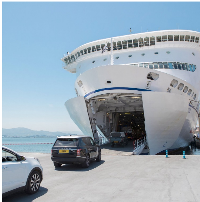
Ilustración 6: Rampa de proa de ferry con compuertas de almeja. Fuente: Brittany Ferries
