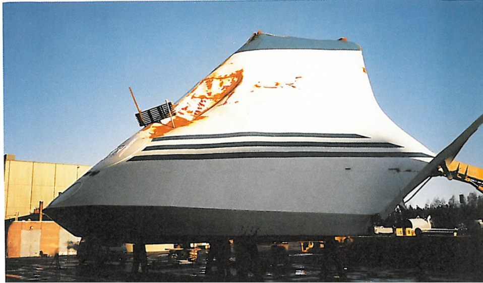
Ilustración 17: Visera de proa recuperada del MS Estonia. Fuente: Informe Oficial
