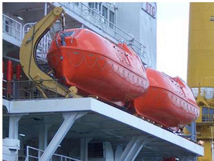
Figura 9. Pescante hidráulico LH-140 MKIII. Viking (2025). Fuente: https://www.viking-life.com/shop/boats-and-davits/davits
