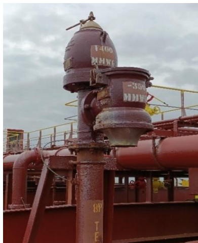
Imagen 17: Válvulas de presión/vacío de +14KPa y -3.5 KPa. Elaboración propia.
