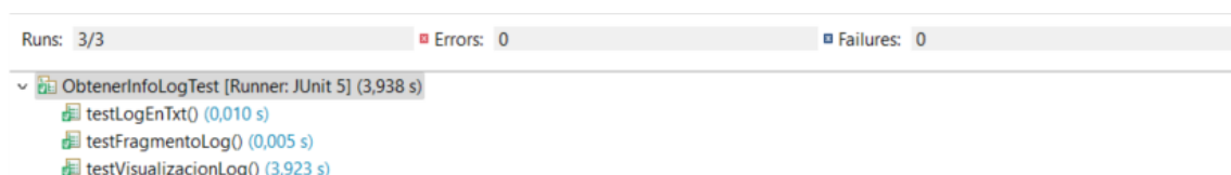
Figura 5.2.1 – Captura que muestra que los test Junit se ejecutan con éxito
