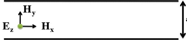
Figura 3.13: Estructura de los campos del modo  $TE_{10}^x$  en una guía de onda rectangular.
