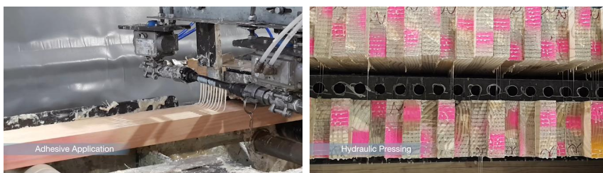
Figura 24. Aplicación del adhesivo en peine (izq.) y prensado (der.) (Techlam, 2020).
