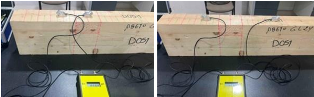
Figura 122. Ensayo con ataque biótico ubicado a 10 cm del transductor emisor. Separaciones de 10 (izq.) y 30 cm (der.).
