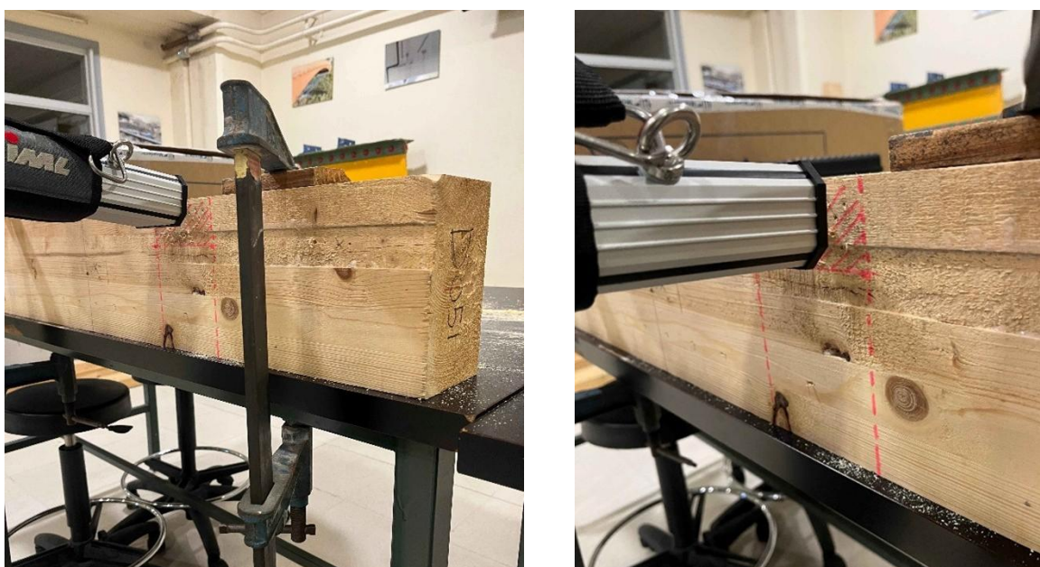
Figura 47. Simulación de ataque biótico mediante perforaciones con resistógrafo.
