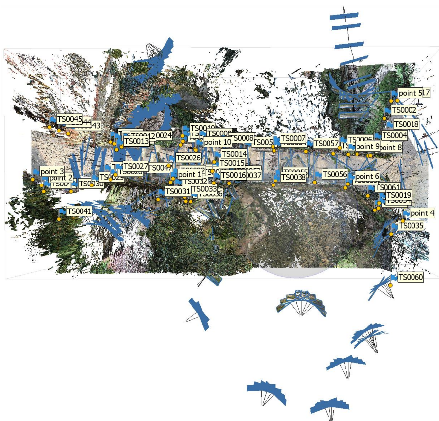
Figura 3-8: Nube de puntos, posición de dianas y posición y dirección de la cámara en el Puente Mayor de Liérganes.
