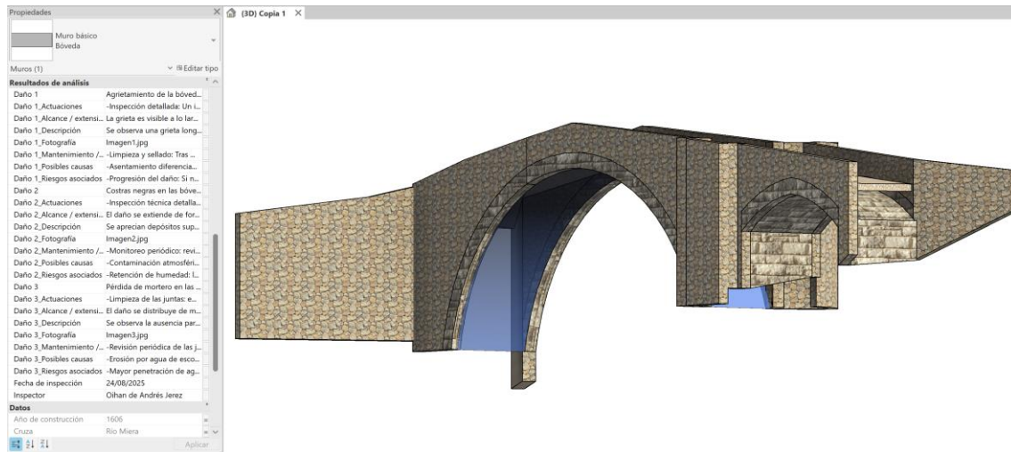
Figura 3-22: Visualización de parámetros asociados a inspecciones en la bóveda mayor del Puente Mayor de Liérganes.
