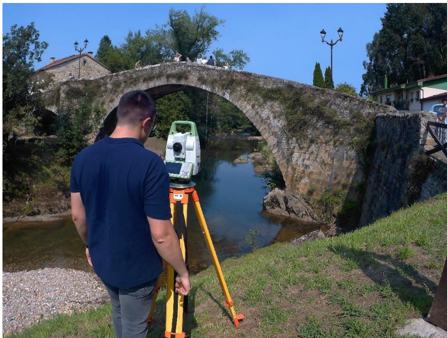
Figura 3-5: Medición de posición de diana mediante estación total.
