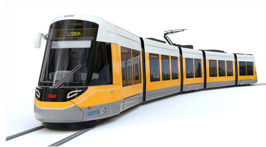
Figura 11.1. Unidad articulada CAF de 5 módulos (33m) para el tranvía Lisboa. Fuente: Urban Transport Magazine
