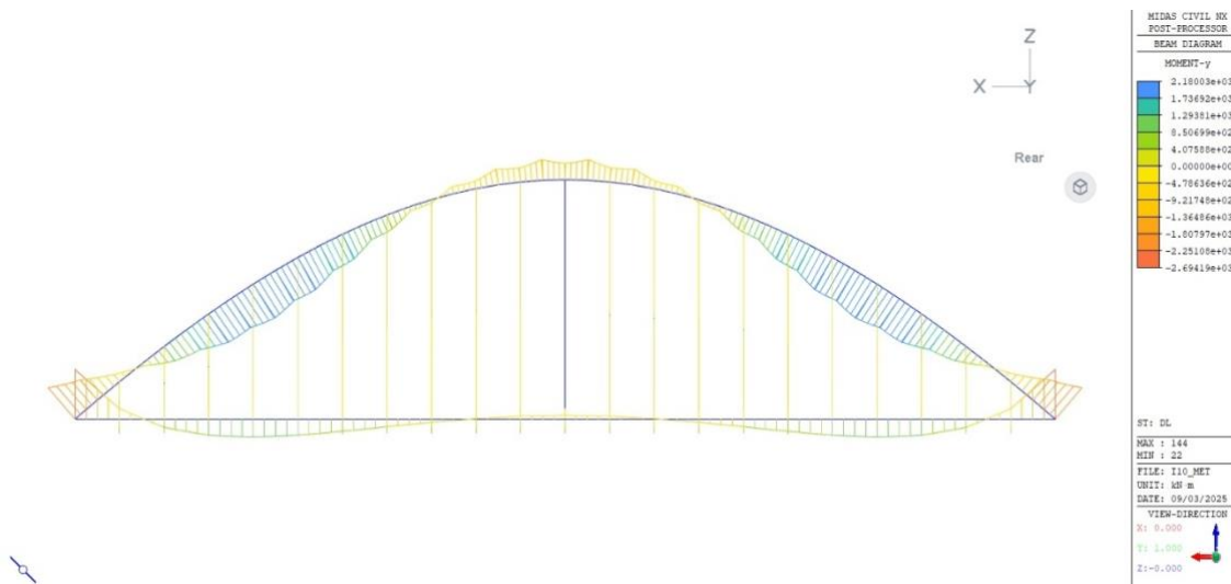
Figura 187. Momentos obtenidos en la fase metálica para la iteración final
