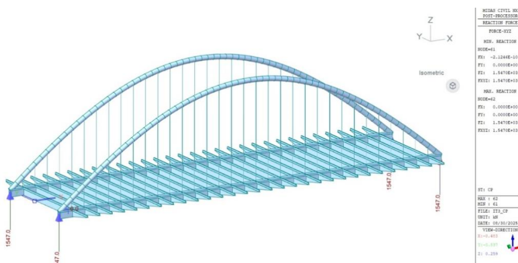
Figura 245. Reacciones en el caso de carga permanente para la iteración 3
