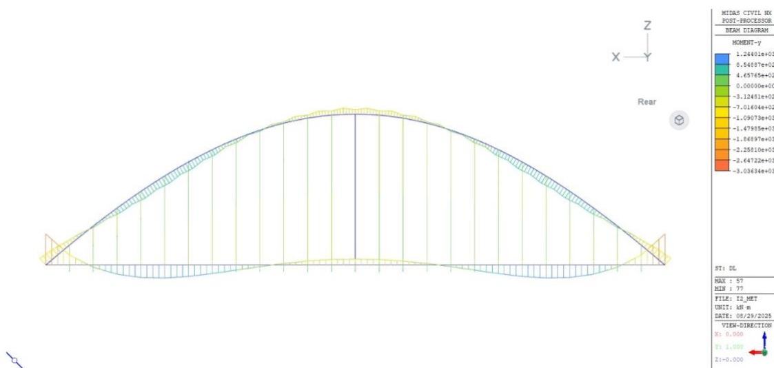
Figura 222. Diagrama de momentos en fase metálica para la iteración 2
