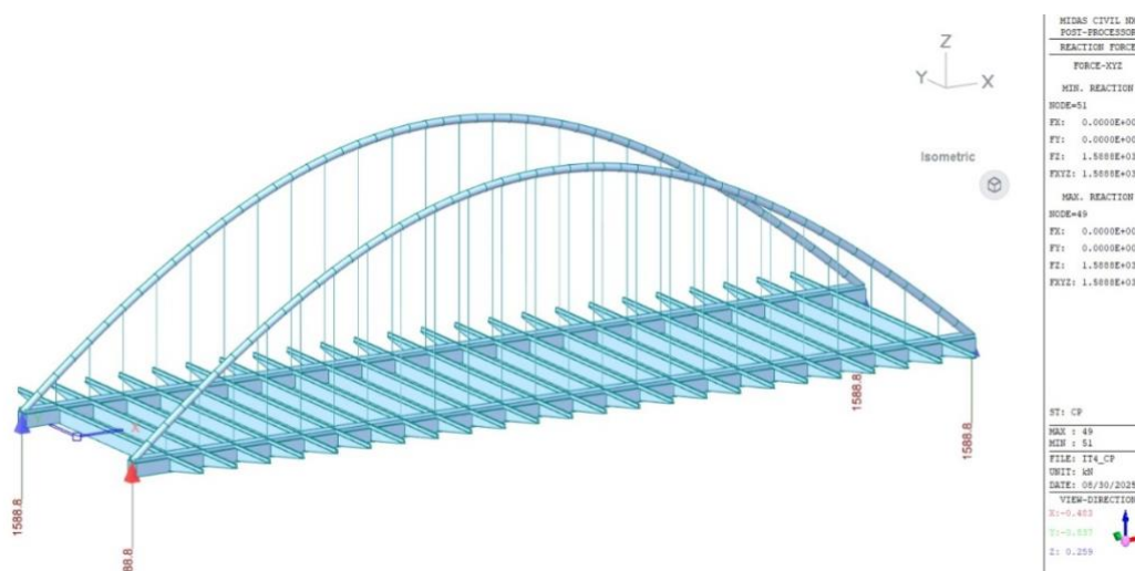
Figura 261. Reacciones en el caso de carga permanente para la iteración 4
