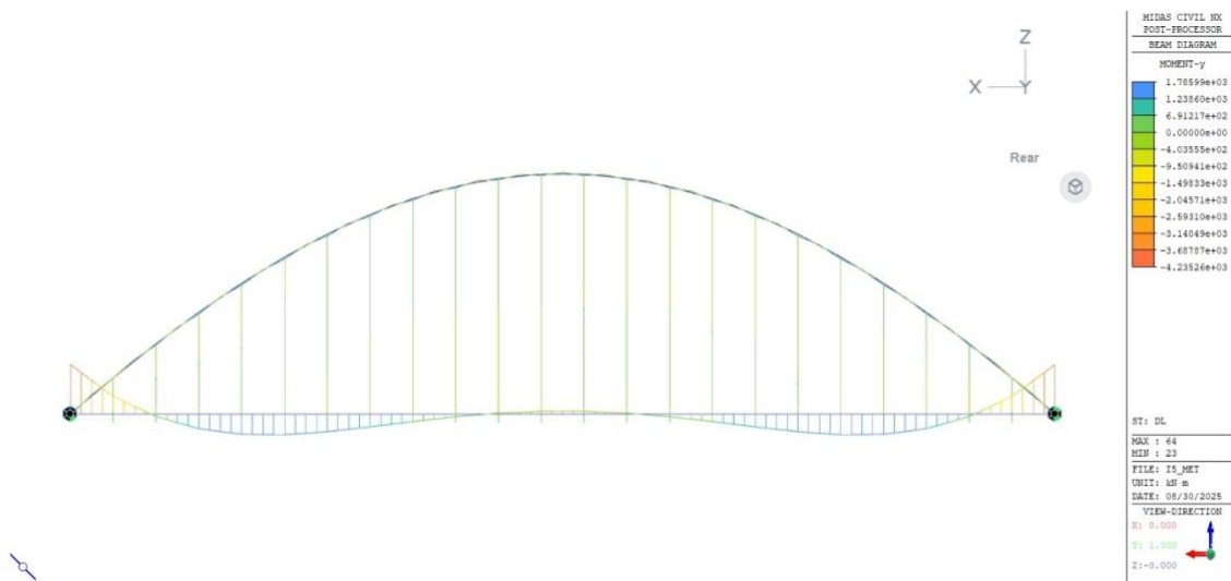
Figura 269. Diagrama de momentos en fase metálica para la iteración 5
