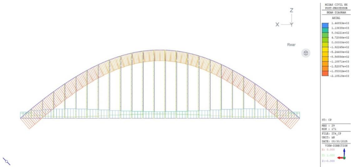
Figura 262. Diagrama de axiles para el caso de carga permanente en la iteración 4
