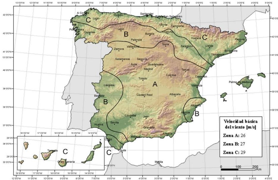
Figura 10: Valor básico de la velocidad del viento ( $V_b$ ) en la península ibérica. Fuente: CTE DB SE-AE
