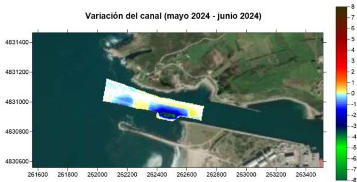
Ilustración 75: Balance sedimentario mayo-junio 2024: Variación de cotas en el canal de entrada al Puerto entre mayo y junio de 2024 (pre y post dragado). Diferencias de cotas en m. Fuente: Elaboración propia en base a levantamiento aportado por la APAV
