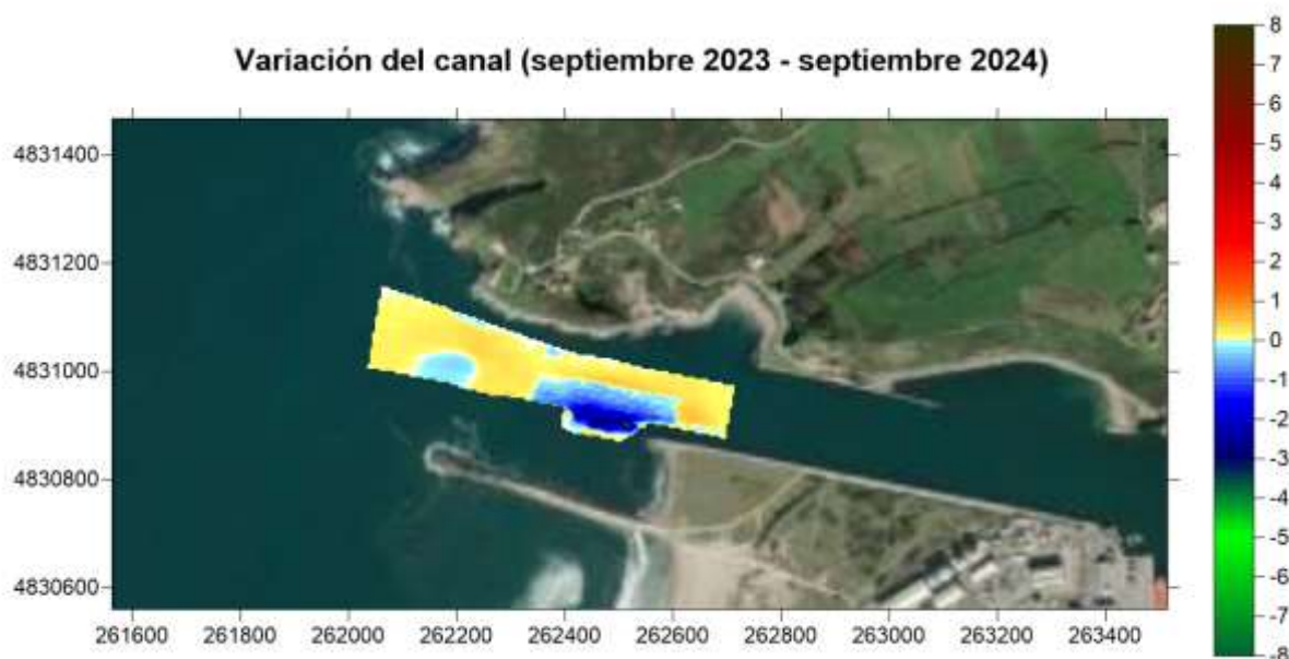
Ilustración 77: Balance sedimentario septiembre 2023 - septiembre 2024: Variación de cotas en el canal de entrada al Puerto entre septiembre 2023 y septiembre 2024. Diferencias de cotas en m. Fuente: Elaboración propia en base a levantamiento aportado por la APAV
