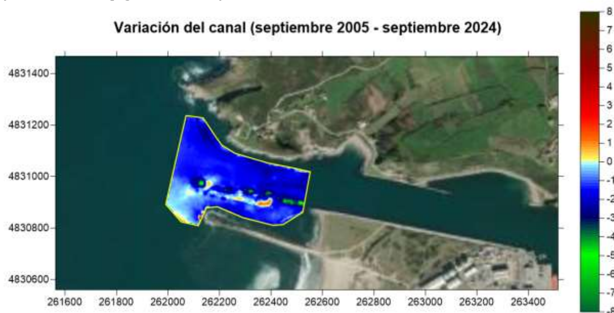
Ilustración 79: Balance sedimentario 2005-2024 en el área de control: Variación de cotas en el canal de entrada al Puerto entre septiembre de 2005 y septiembre de 2024. Diferencias de cotas en m. Fuente: Elaboración propia en base a levantamiento aportado por la APAv
