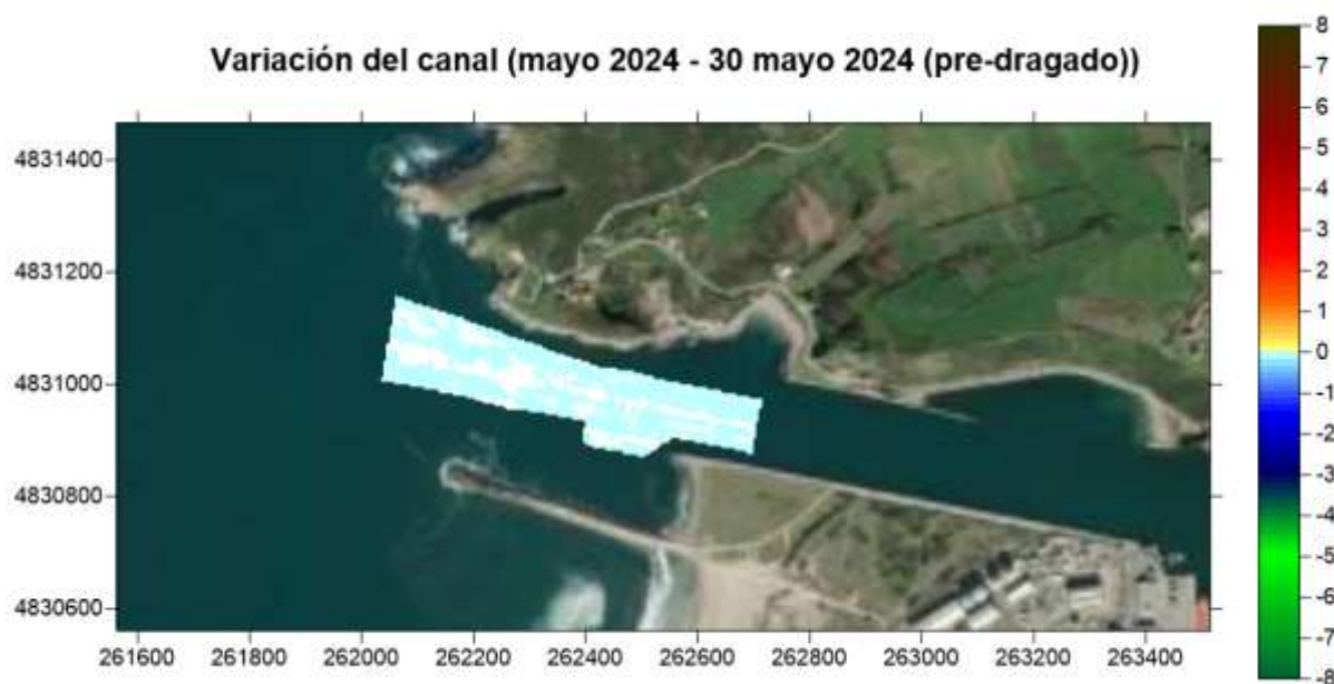
Ilustración 74: Balance sedimentario mayo 2024 - campaña 30 de mayo 2024 (predragado): Variación de cotas en el canal de entrada al Puerto en mayo 2024. Diferencias de cotas en m. Fuente: Elaboración propia en base a levantamiento aportado por la APAV
