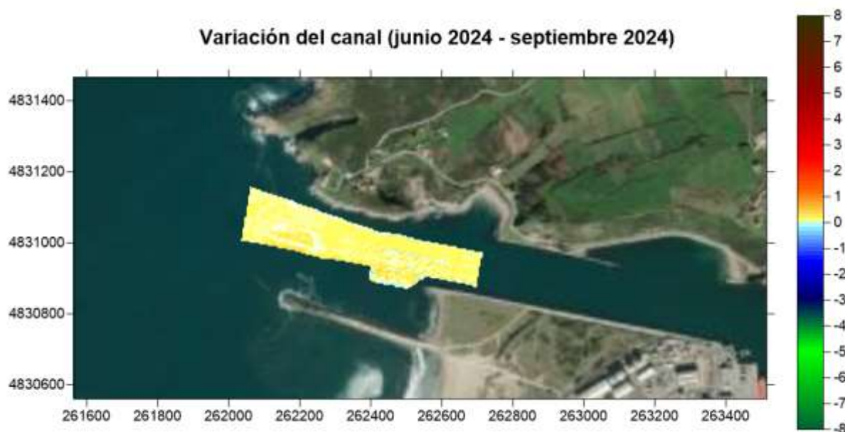
Ilustración 76: Balance sedimentario junio 2024 - septiembre 2024: Variación de cotas en el canal de entrada al Puerto entre junio 2024 y septiembre 2024. Diferencias de cotas en m. Fuente: Elaboración propia en base a levantamiento aportado por la APAV
