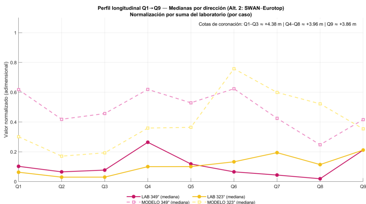
Ilustración 42: LAB vs MODELO alt.2 por sensor (Q1–Q9) — Perfil longitudinal normalizado - 323° y 349°.
