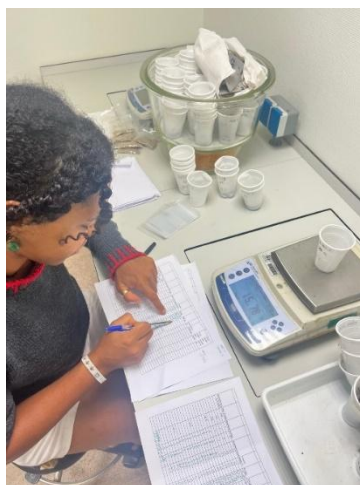
Figura 26. Procesado de las muestras de sedimento tomadas con las jeringuillas una vez pasadas las 48h de secado en la estufa.
