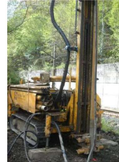
Figura 1. Detalle de sonda que se emplea para la extracción de testigos.
