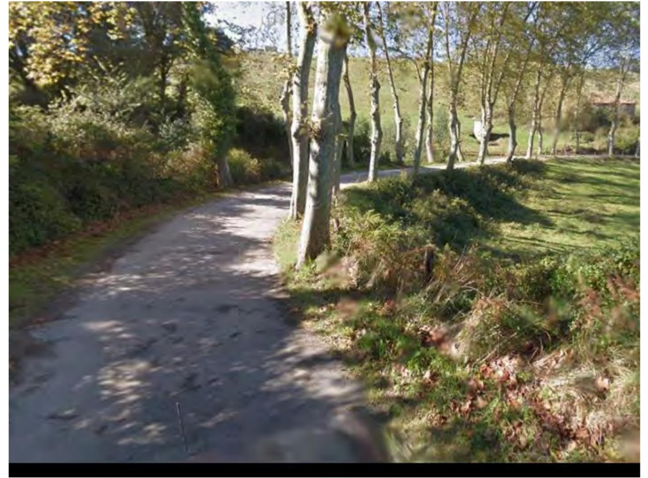
*Imagen 5. Imagen de la ausencia de sistema de drenaje, tanto longitudinal como transversal.*
