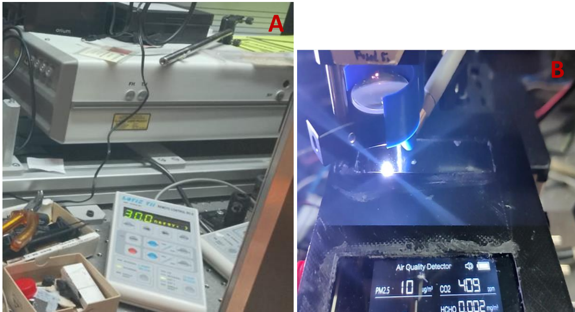
Figura 5.1. (A) Imagen del láser de doble pulso Q-Switched Nd:YAG Lotis LS-2134D y panel de control, utilizado como fuente de bombeo para irradiar una muestra de aire requerida en la producción de plasma. (B) Emisión de luz por parte del plasma inducido con láser IR a 1064 nm sobre muestra de aire dentro de la celda.
