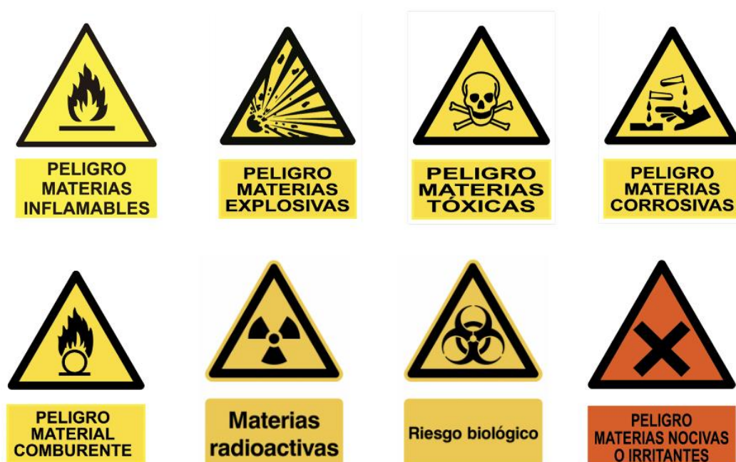
Figura 5: Señalización de peligros por sustancias
