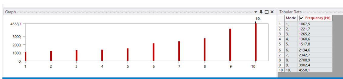
Figura 69: Frecuencias naturales de la etapa ordinaria helicoidal con la geometría de aligeramiento 5 en la corona
