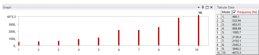
Figura 66: Frecuencias naturales de la etapa ordinaria helicoidal con la geometría de aligeramiento 2 en la corona
