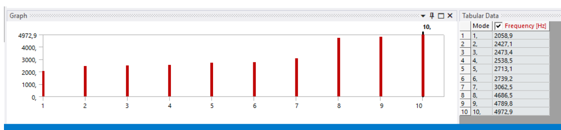
Figura 61: Frecuencias naturales de la etapa planetaria con la geometría de aligeramiento 4 en los planetas
