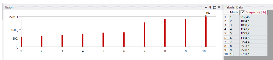
Figura 70: Frecuencias naturales de la etapa ordinaria helicoidal con la geometría de aligeramiento 6 en la corona
