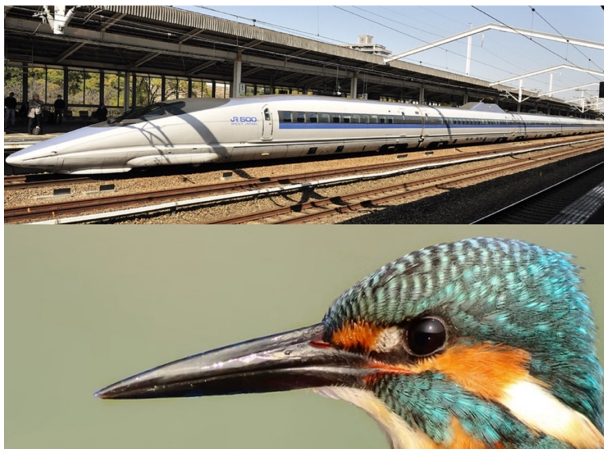
Figura 5: Tren Shinkansen y martín pescador, inspiración biomimética en el diseño aerodinámico
