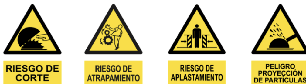
Figura 1: Señalización de peligros mecánicos
