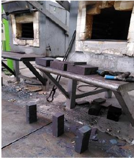
Figura 28. Bloques enfriando al aire después de su austenización (RFC).
