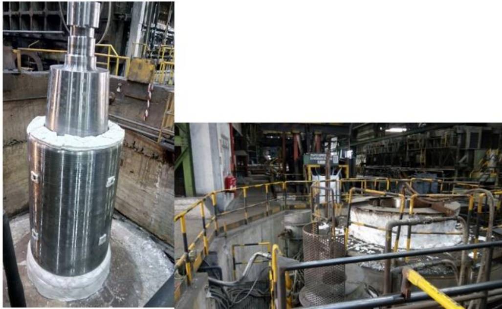
Figura 21. Colocación del cilindro en el horno vertical (RFC).
