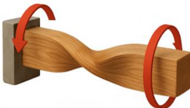
Figura 21. Torsión de una viga de madera, imagen generada con IA.
