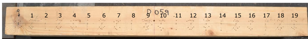
Figura 129. Cara superior de la viga sana D059 de madera de abeto GL28.
