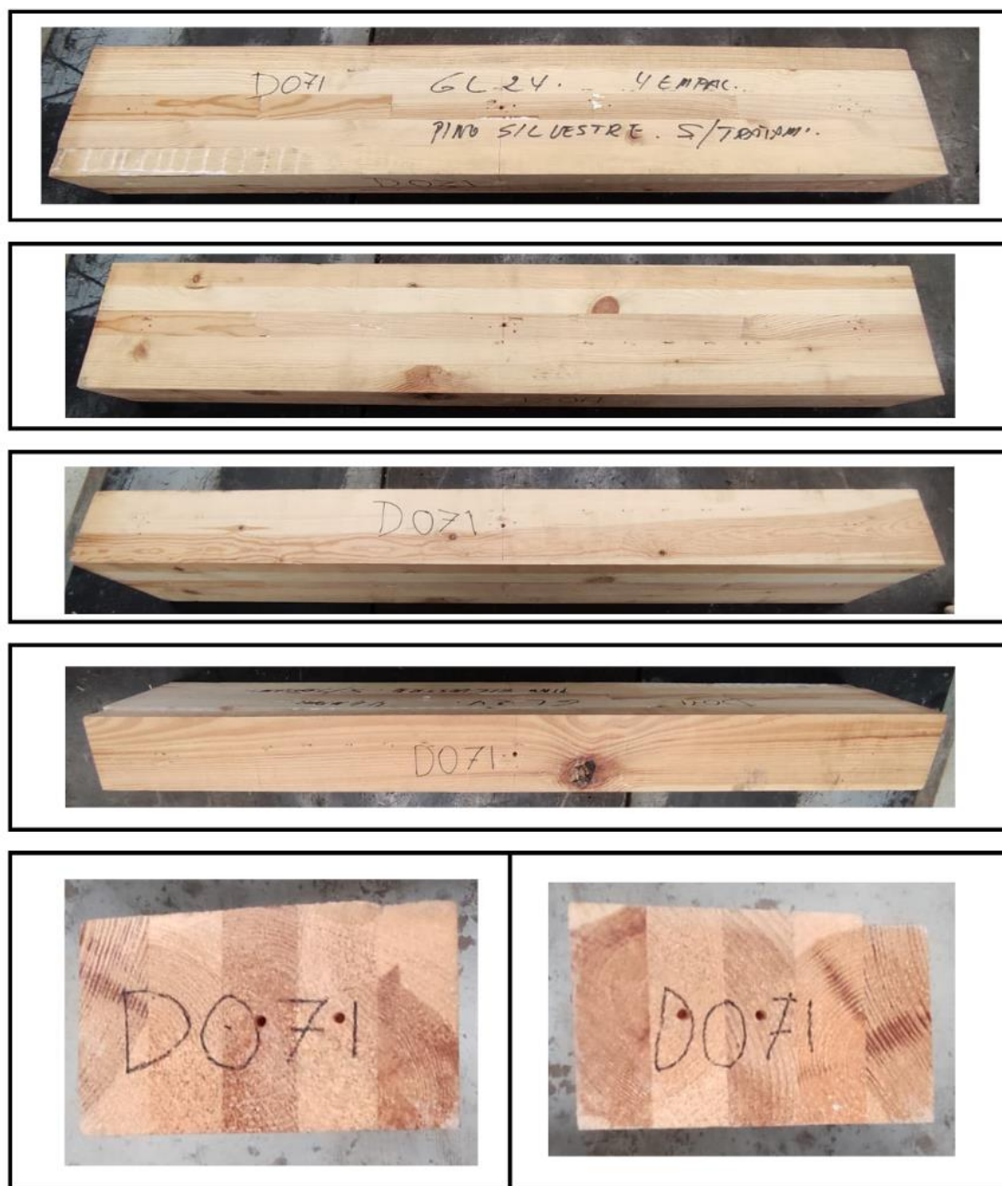
Figura 179. Estado inicial de la viga GLULAM sana D071 de pino silvestre sin tratamiento (GL24).
