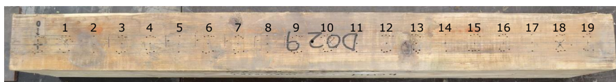
Figura 123. Cara superior de la viga sumergida D029 de madera de pino silvestre tanalizado GL28.
