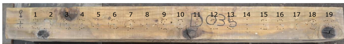
Figura 119. Cara superior de la viga sumergida D035 de madera de pino silvestre tanalizado GL18.
