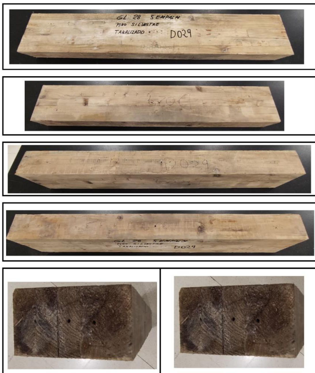
Figura 189. Estado inicial de la viga GLULAM sumergida D029 de pino silvestre tanalizado (GL28).
