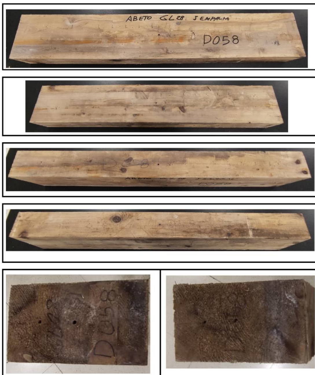
Figura 195. Estado inicial de la viga GLULAM sumergida D058 de abeto (GL28).
