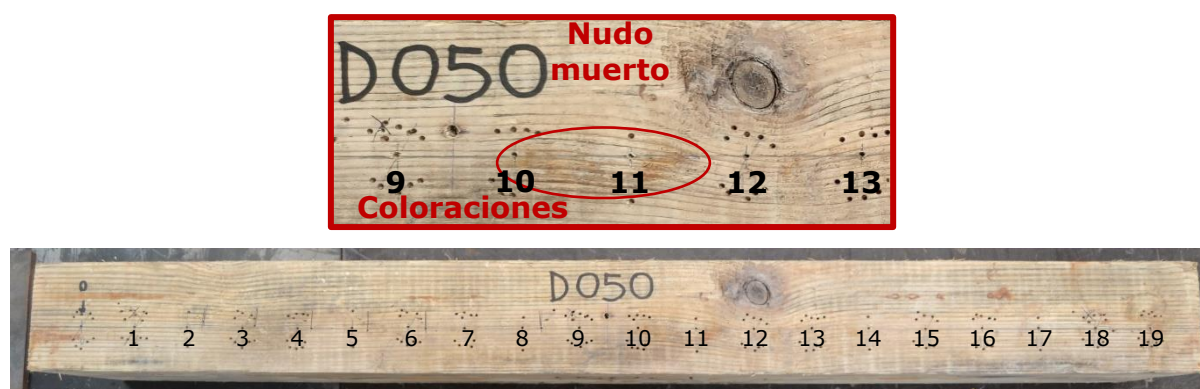
Figura 133. Cara superior de la viga sumergida D050 de madera de abeto GL24.
