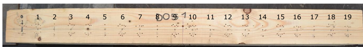
Figura 127. Cara superior de la viga sana D051 de madera de abeto GL24.
