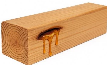
Figura 33. Bolsa de resina en viga de madera, imagen generada con IA.
