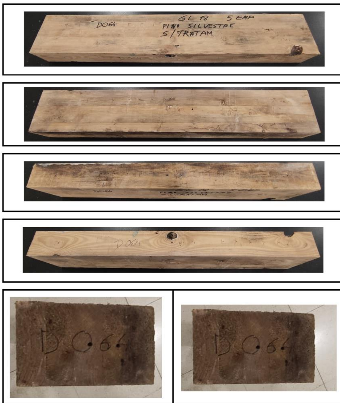
Figura 181. Estado inicial de la viga GLULAM sumergida D064 de pino silvestre sin tratamiento (GL18).
