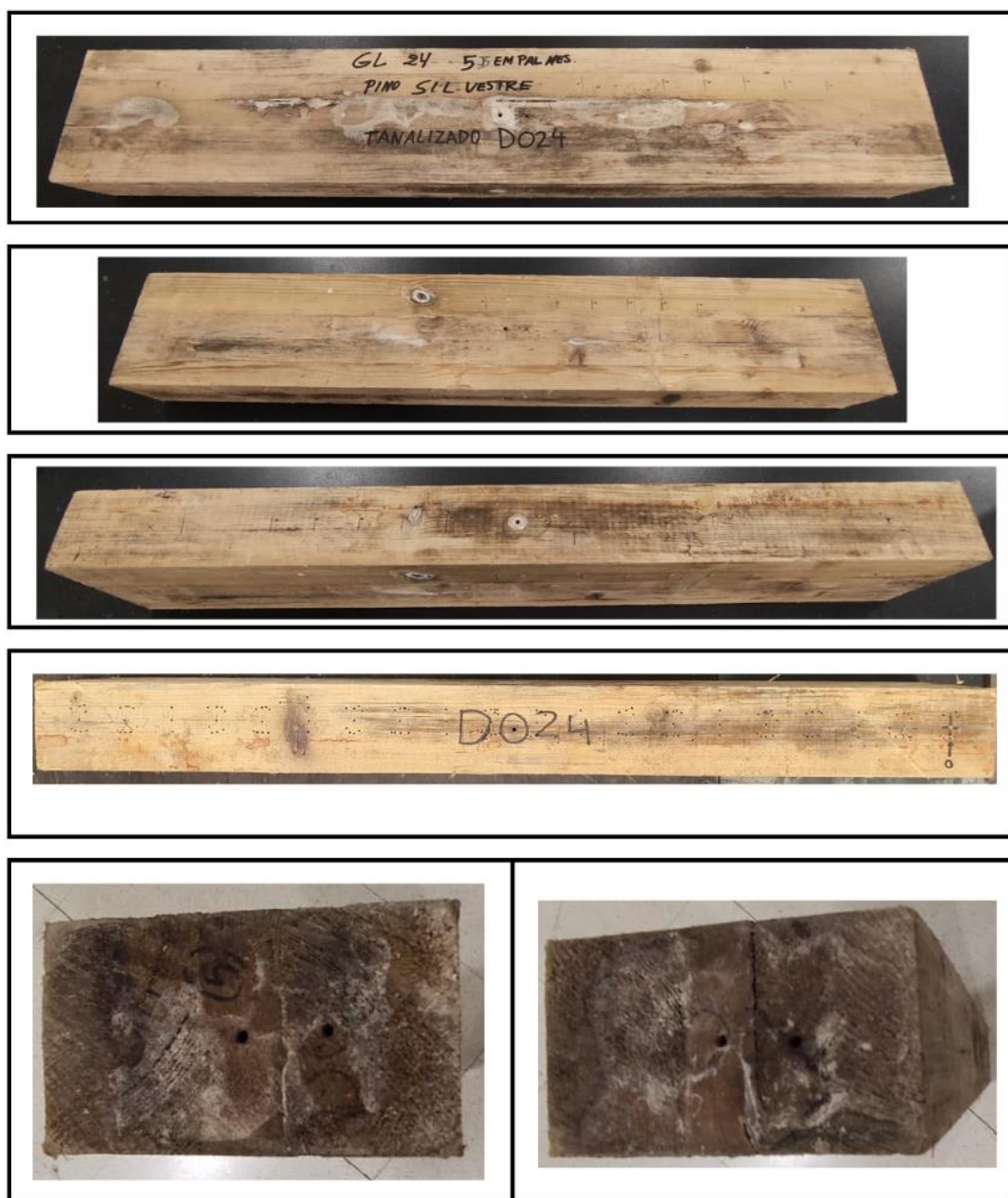
Figura 188. Estado inicial de la viga GLULAM sumergida D024 de pino silvestre tanalizado (GL24).
