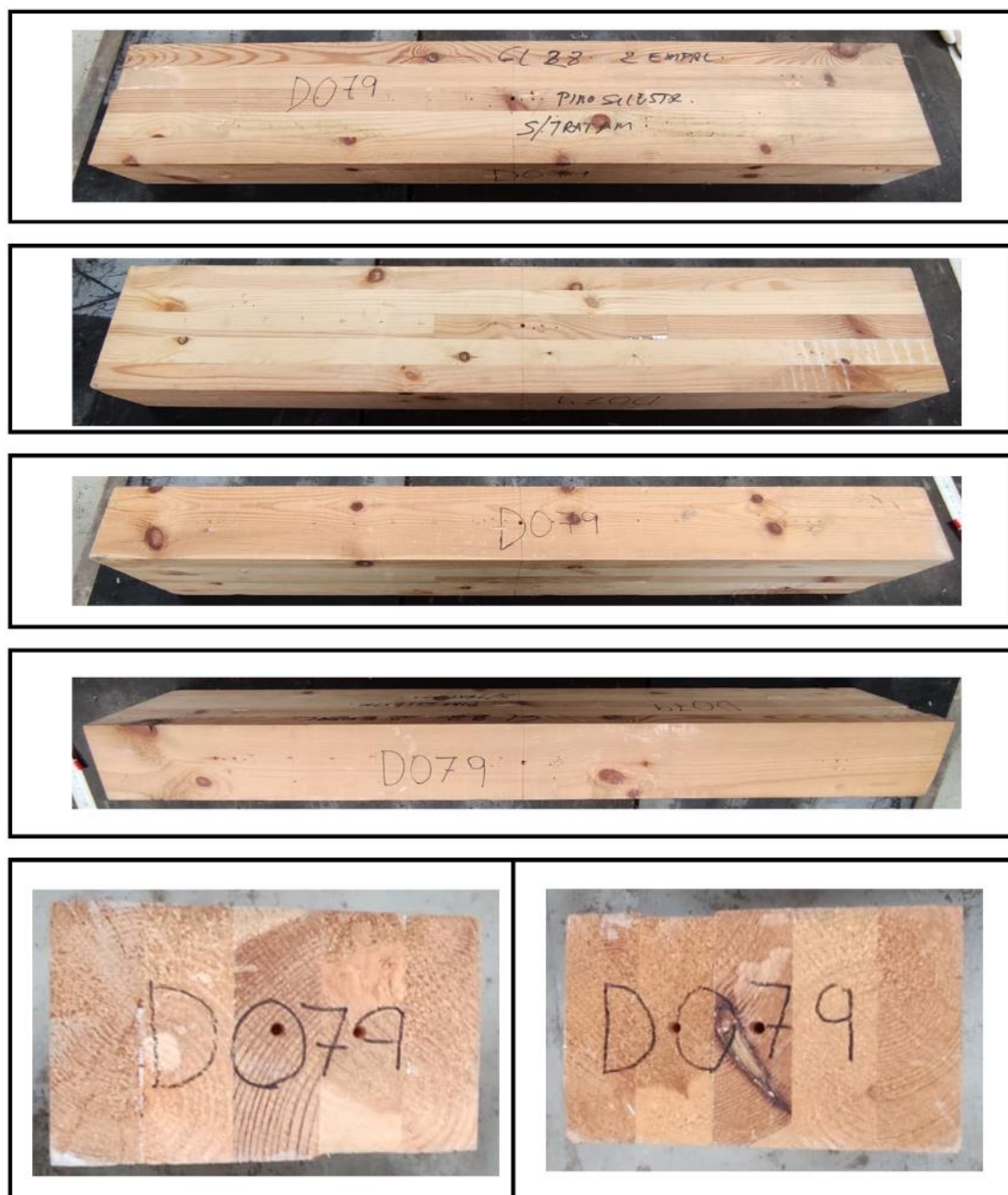
Figura 180. Estado inicial de la viga GLULAM sana D079 de pino silvestre sin tratamiento (GL28).
