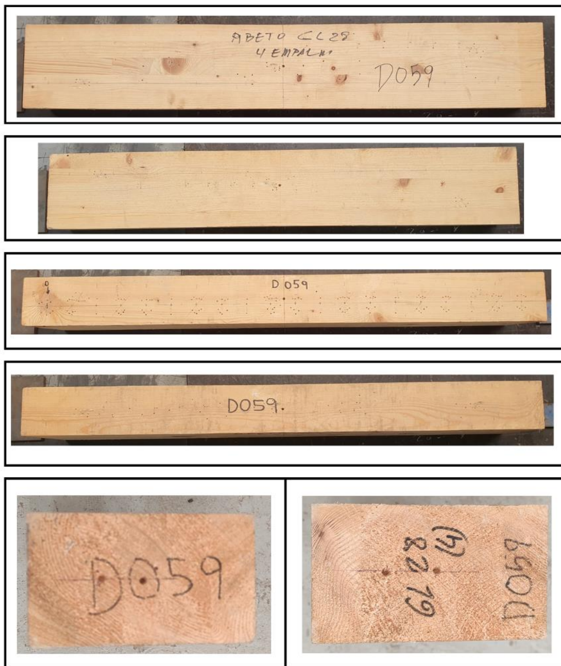
Figura 192. Estado inicial de la viga GLULAM sana D059 de abeto (GL28).
