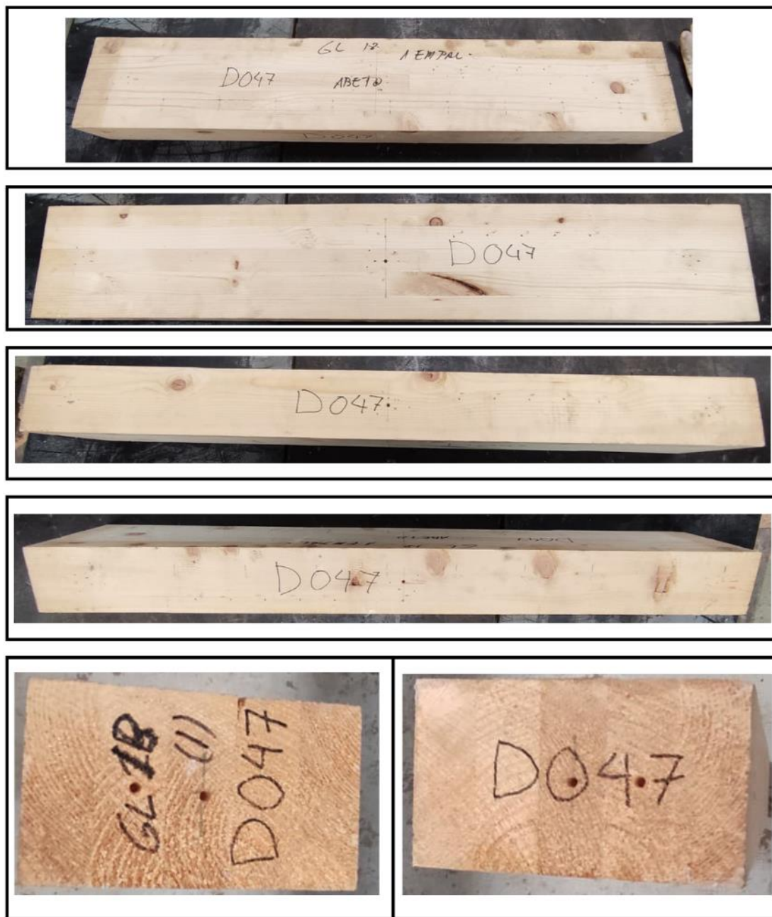
Figura 190. Estado inicial de la viga GLULAM sana D047 de abeto (GL18).
