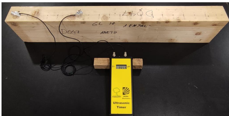
Figura 94. Ensayo de UT en la zona 1. El palpador emisor se coloca en el punto 0 y se mantiene fijo mientras el palpador receptor se va desplazando longitudinalmente entre las marcas 0-8.
