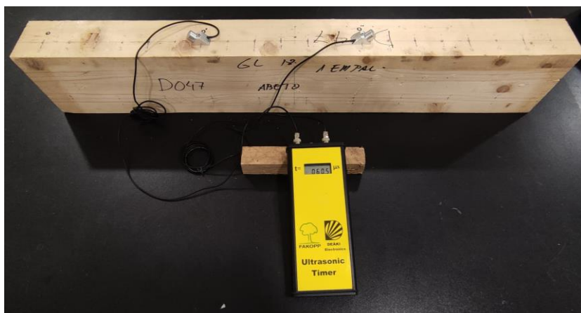
Figura 96. Ensayo de UT en la zona 2. El palpador emisor se coloca en el punto 0' y se mantiene fijo mientras el palpador receptor se va desplazando longitudinalmente entre las marcas 6-14.
