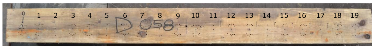
Figura 135. Cara superior de la viga sumergida D058 de madera de abeto GL28.
