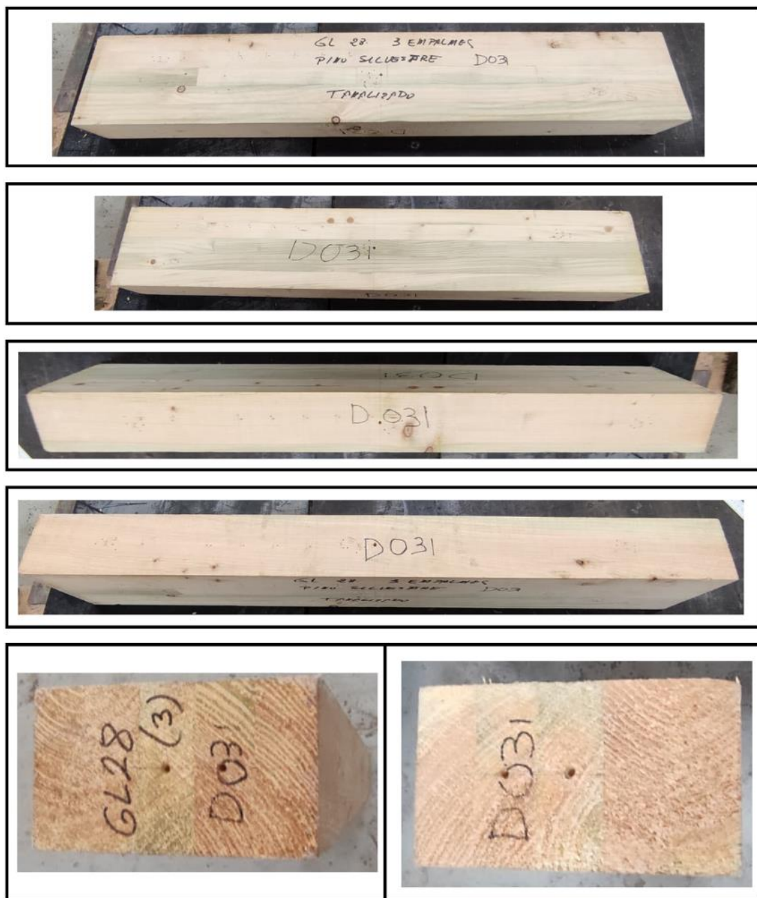
Figura 186. Estado inicial de la viga GLULAM sana D031 de pino silvestre tanalizado (GL28).
