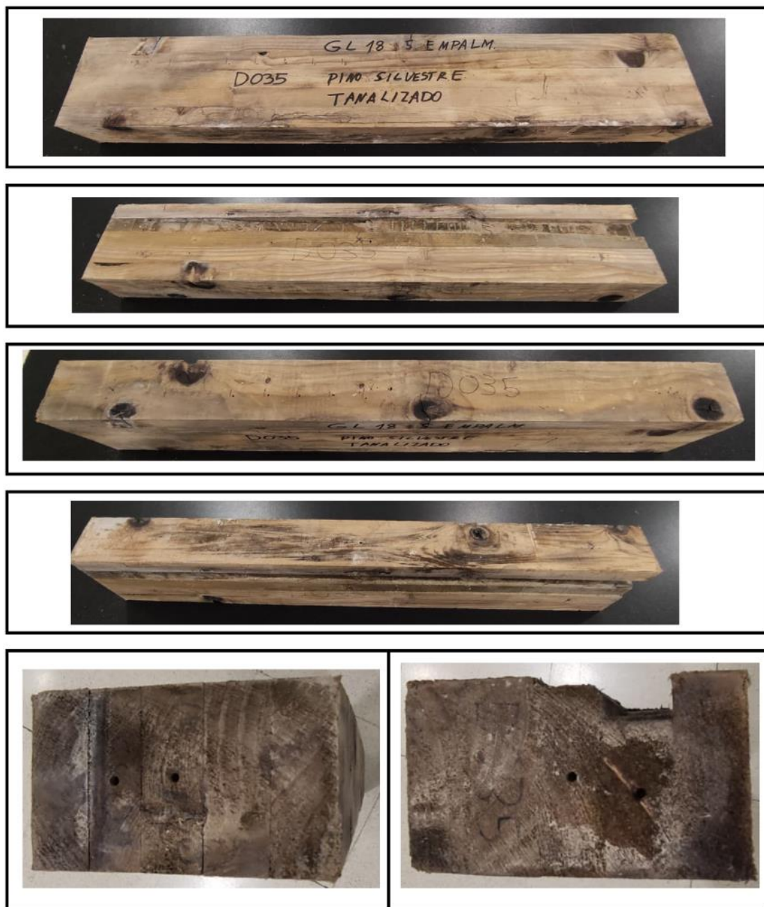
Figura 187. Estado inicial de la viga GLULAM sumergida D035 de pino silvestre tanalizado (GL18).
