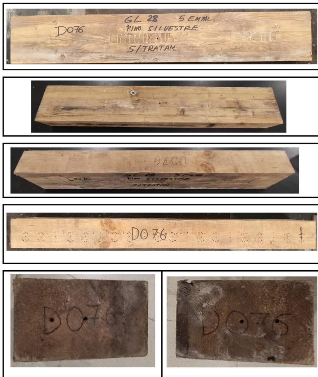
Figura 183. Estado inicial de la viga GLULAM sumergida D076 de pino silvestre sin tratamiento (GL28).
