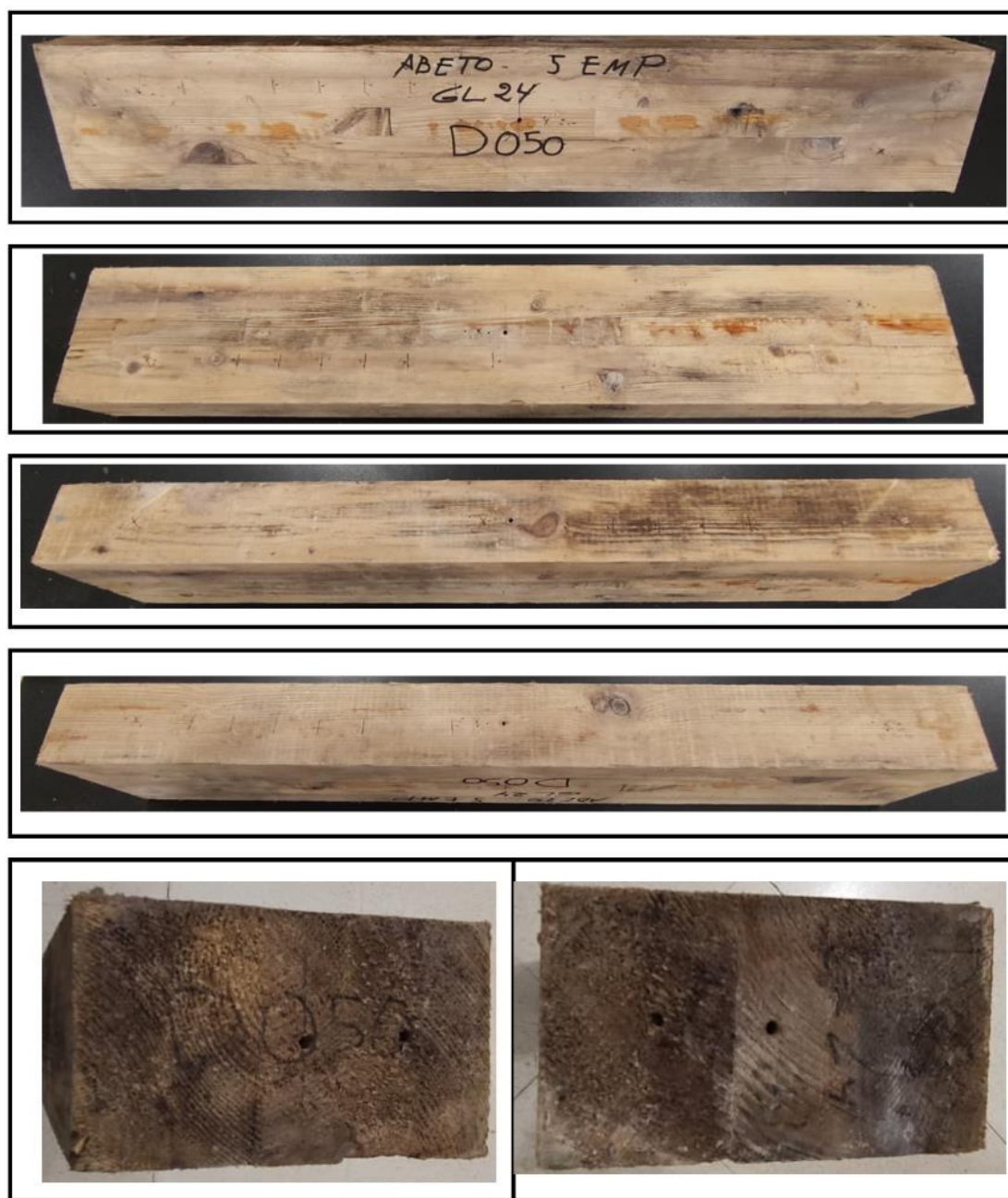
Figura 194. Estado inicial de la viga GLULAM sumergida D050 de abeto (GL24).
