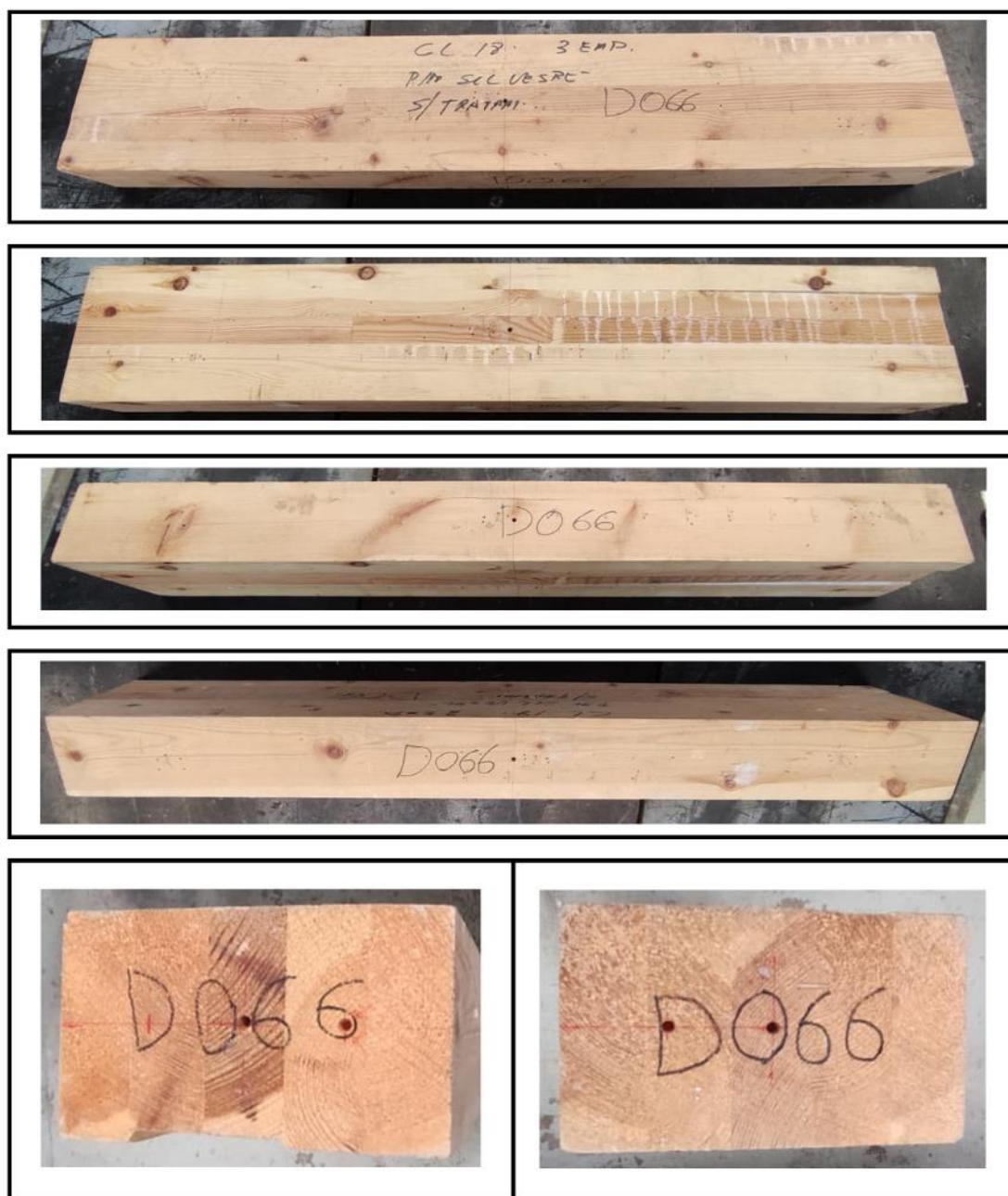
Figura 178. Estado inicial de la viga GLULAM sana D066 de pino silvestre sin tratamiento (GL18).
