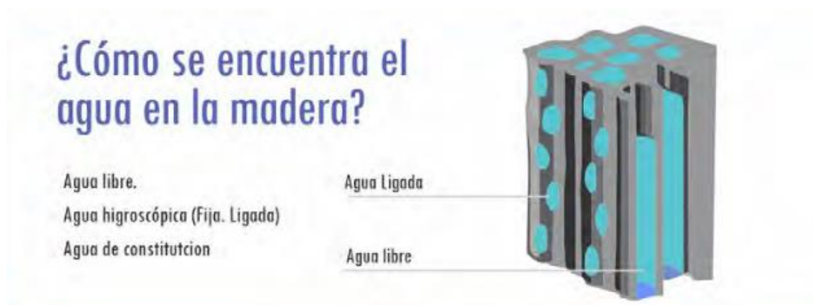
Figura 51. Estado del agua en el interior de la madera (Umlandt et al., 2022).
