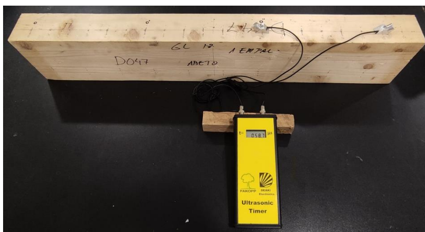
Figura 98. Ensayo de UT en la zona 3. El palpador emisor se coloca en el punto 0'' y se mantiene fijo mientras el palpador receptor se va desplazando longitudinalmente entre las marcas 12-20.
