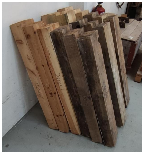
Figura 63. Muestra de 18 probetas de madera para Fases 1 y 2 de la campaña experimental.
