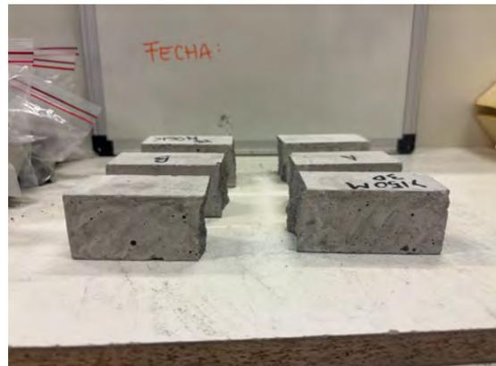
(b) Probeta post-ensayo de flexión (vista en planta).
