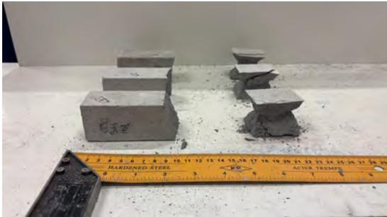
(a) Probeta post-ensayo de compresión (vista frontal).
