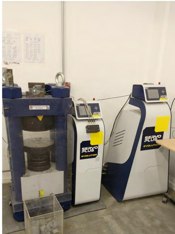
Figura 3.12: Máquina utilizada para el ensayo de compresión. Fuente: Elaboración propia.
