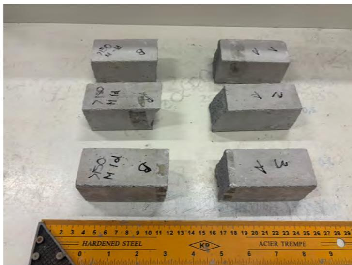
Figura 8.5: Probeta post-ensayo de flexión (vista en planta). Fuente: Elaboración propia.
