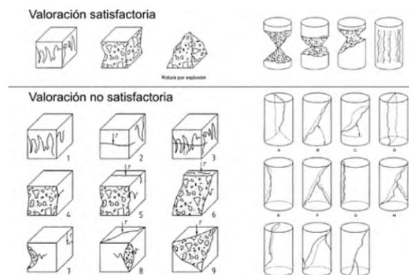
Figura 3.14: Esquemas de modos de rotura en compresión.
