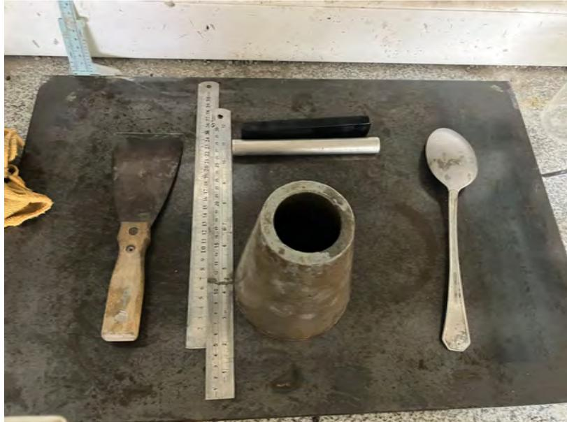
Figura 3.8: Fotografía de los instrumentos utilizados en el ensayo de consistencia. Fuente: Elaboración propia.
