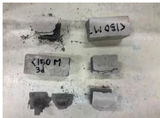
(b) Probeta post-ensayo de compresión (vista en planta).
