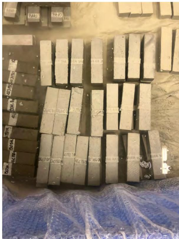
Figura 3.9: Fotografía de las probetas durante el curado en agua saturada en cal. Fuente: Elaboración propia.
