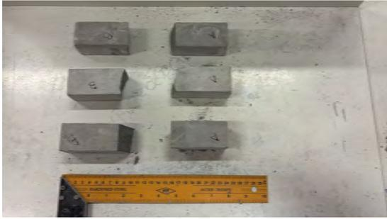
(a) Probeta post-ensayo de flexión (vista en planta).
