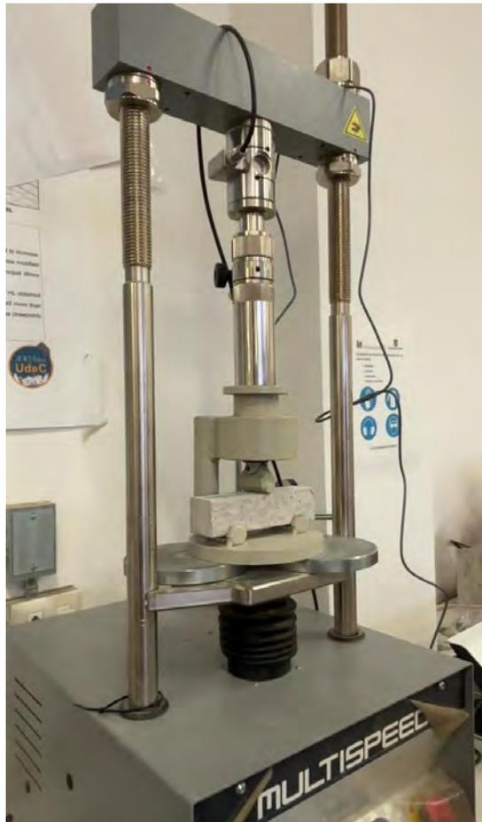
Figura 4.19: Máquina de ensayo utilizada para pruebas de flexión en probetas.
