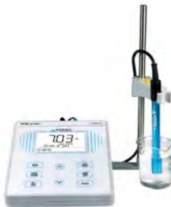
Figura 3.6: Medidor de pH utilizado en los ensayos.
