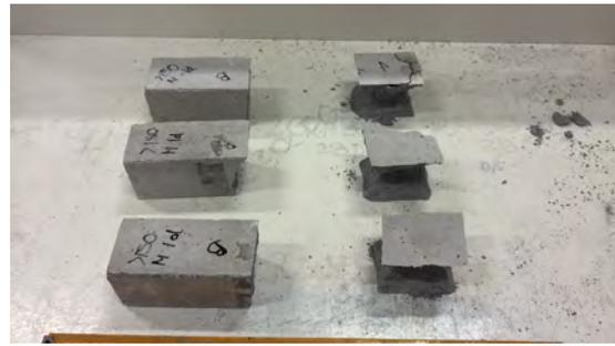
(b) Probeta post-ensayo de compresión (vista en planta).
