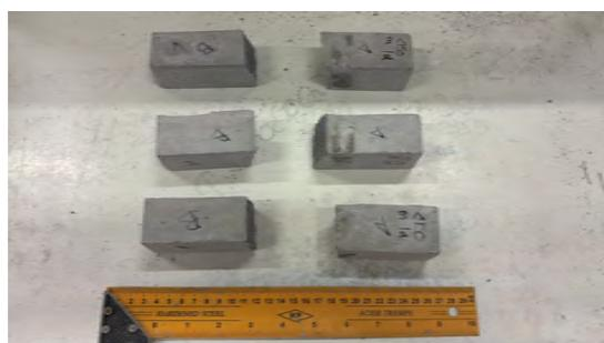
(b) Probeta post-ensayo de flexión (vista en planta).
