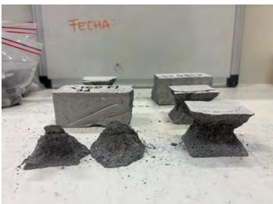
(a) Probeta post-ensayo de compresión (vista frontal).
