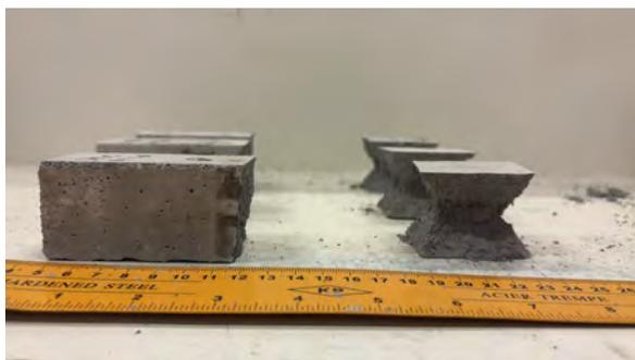
Figura 3.13: Probetas tras el ensayo de compresión. Fuente: Elaboración propia.
