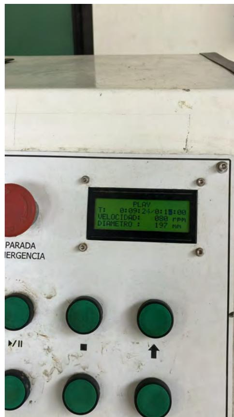
Figura 3.7: Fotografía del panel de mando del molino de bolas utilizado en el ensayo. Fuente: Elaboración propia.
