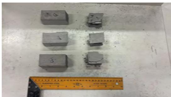
Figura 8.1: Probeta post-ensayo de compresión. Fuente: Elaboración propia.
