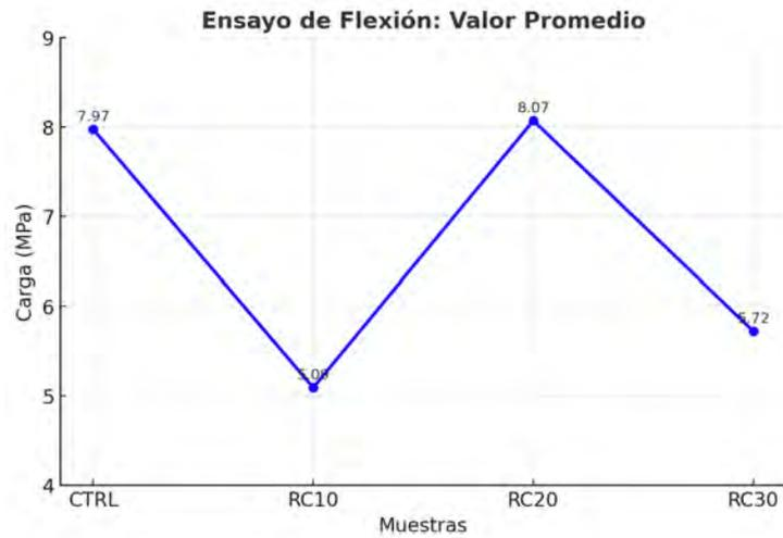
Figura 4.18: Gráfico valores promedio ensayo de resistencia a la flexión. Fuente: Elaboración propia.
