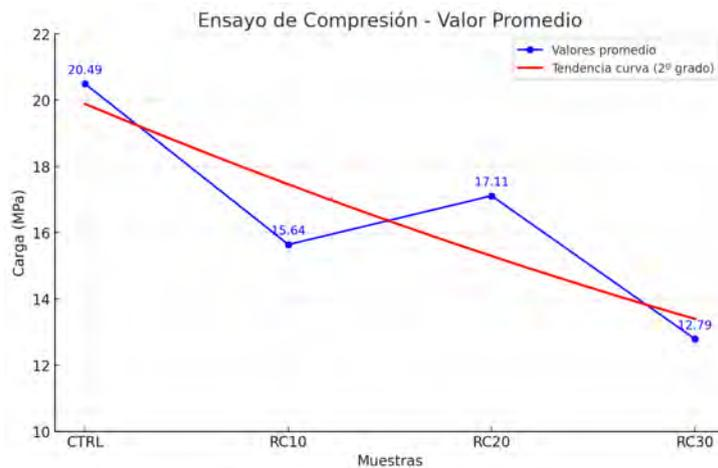
Figura 4.17: Gráfico valores promedio ensayo de resistencia a la compresión. Fuente: Elaboración propia.
