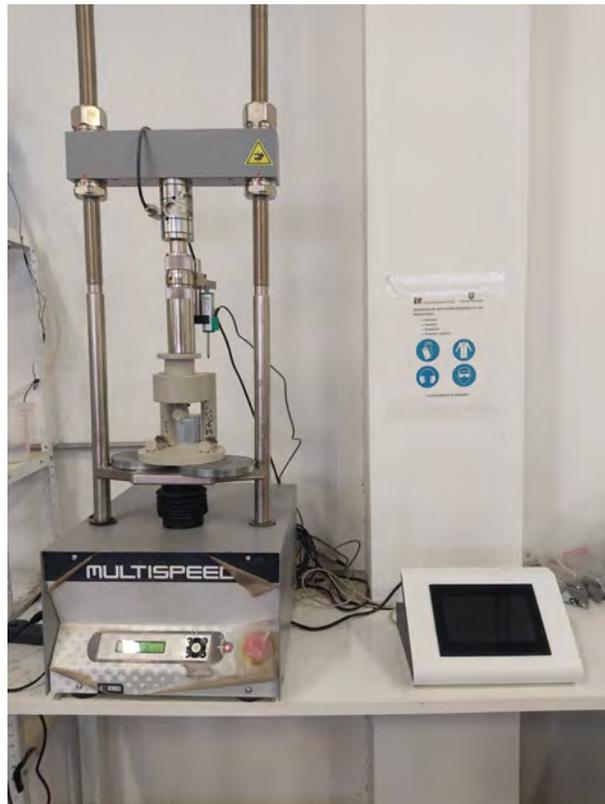
Figura 3.11: Máquina utilizada para el ensayo de flexión. Fuente: Elaboración propia.
