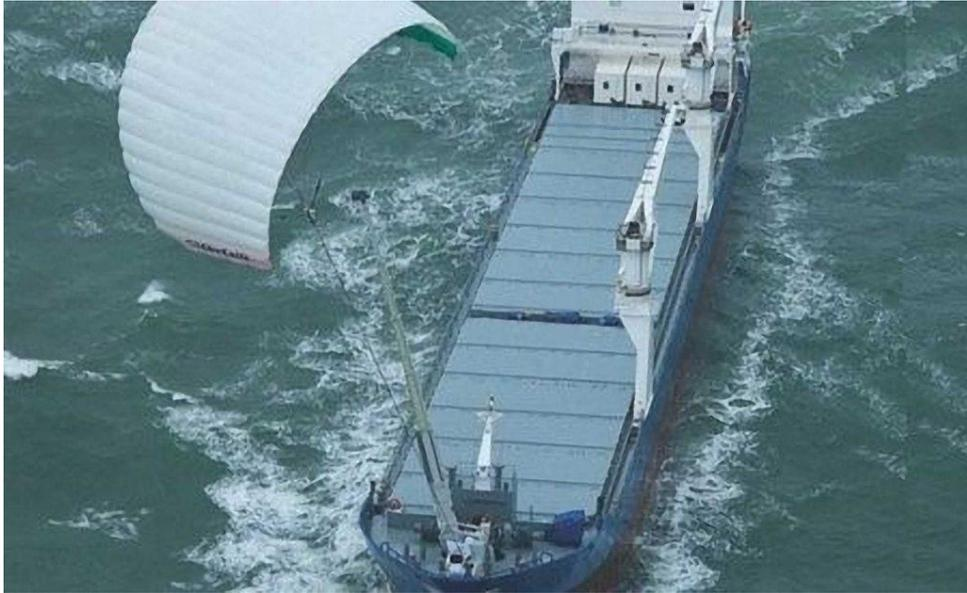
*Figura 3: Buque siendo propulsado adicionalmente con una cometa*
