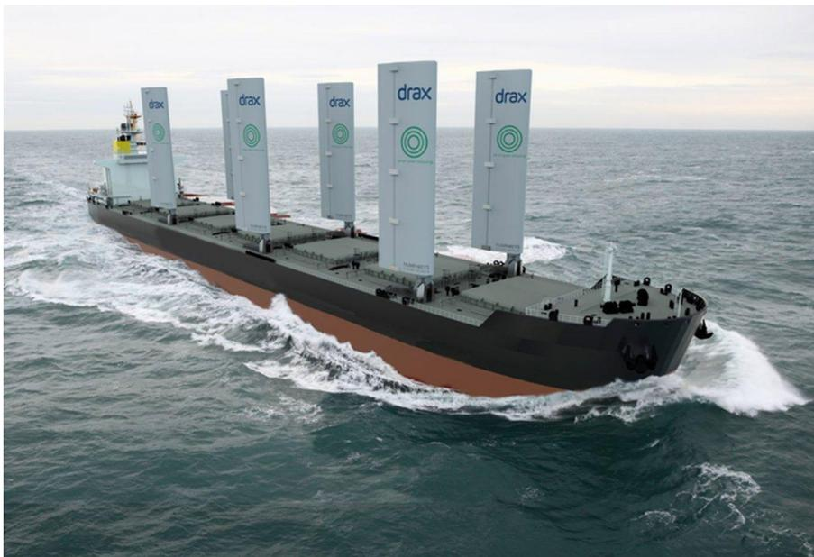
*Figura 4: Buque siendo propulsado adicionalmente por una vela rígida [6]*
