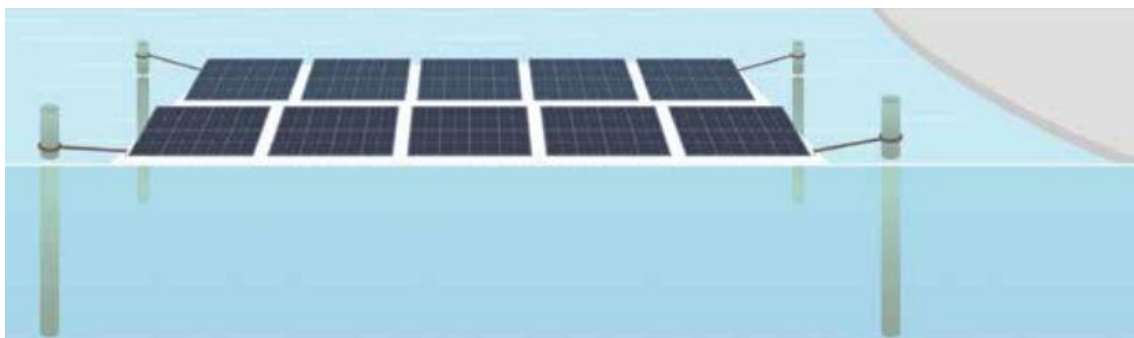
Figura 2-7. Anclaje con pontones [2]
