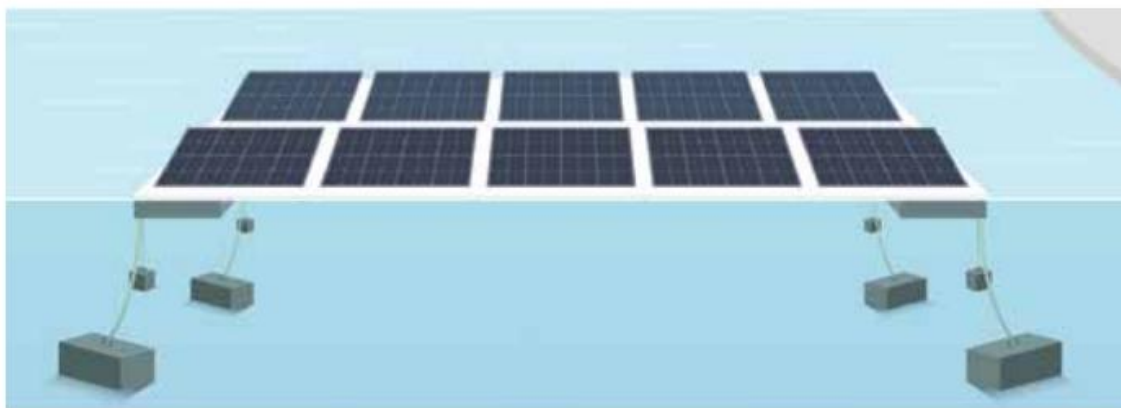
Figura 2-5. Anclaje a fondo con bloque de hormigón [2]
