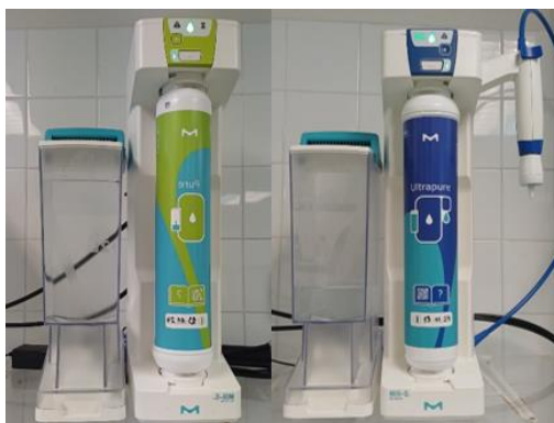
Figura 6: Equipo de purificación de agua. a) Módulo de agua tipo III b) Módulo de agua tipo I.
