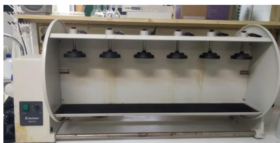
Figura 7. Rotador o agitador usando en el ensayo de lixiviación
