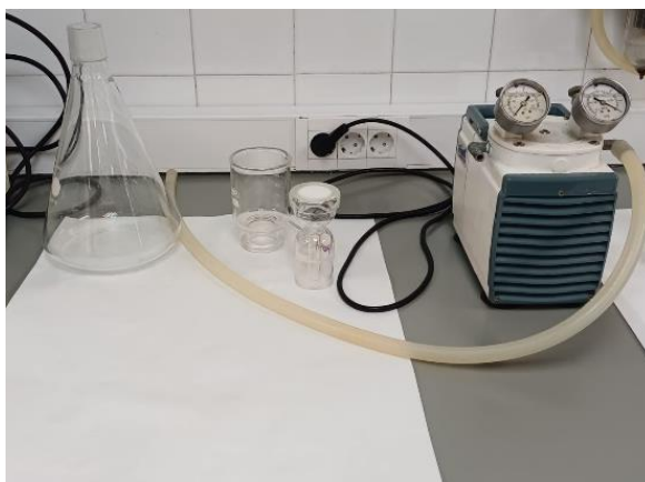
Figura 8. Equipo de filtración usado en el ensayo de lixiviación
