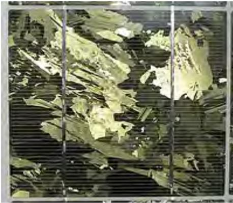
Una célula fotovoltaica basada en silicio multicristalino.
