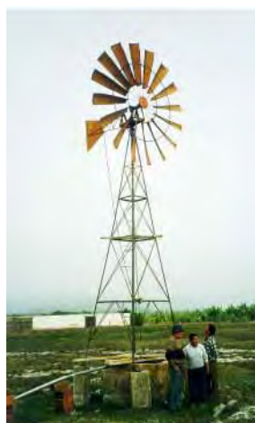
Ilustración 4: Molino de bombeo. Los molinos de bombeo son los dispositivos eólicos fabricados en mayor número a lo largo de la historia. FUENTE: www.arrakis.nl/reports/pr-98-02-1-def(sp).pdf
