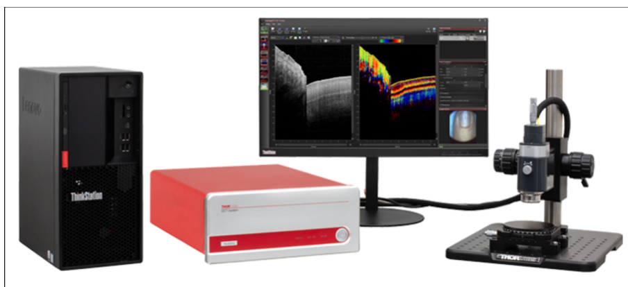
Figura 3.1: Sistema OCT del Grupo de Ingeniería Fotónica (GIF), Universidad de Cantabria. Imagen obtenida de [29].
