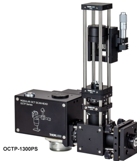
Figura 3.2: Sistema de escaneo OCTP1300PS. Imagen obtenida de [29].
