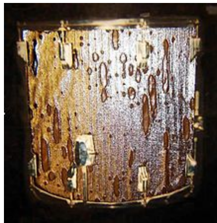
Fallo del recubrimiento por elevada temperatura
