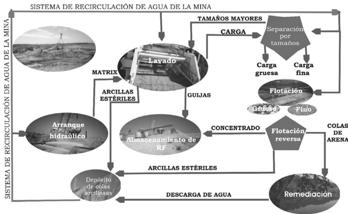
Esquema de explotación y tratamiento de rocas fosfáticas
