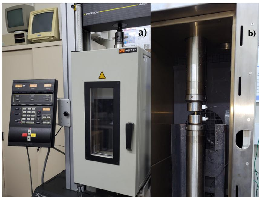
**Figura 16:** Instron 4400 con la cámara de temperatura a) cerrada; b) abierta, permitiendo ver una muestra colocada en el sistema de mordazas.
