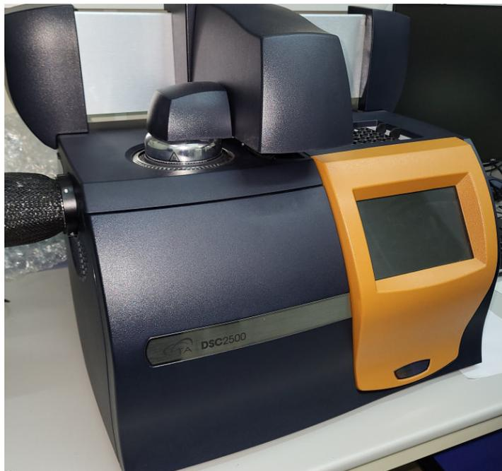
**Figura 15:** DSC2500 para ensayos de calorimetría
