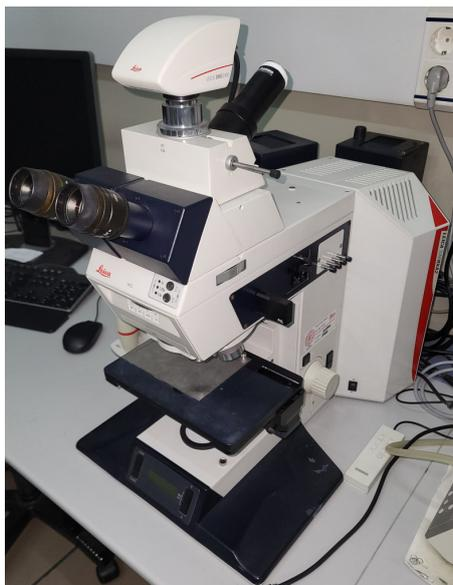
Figura 14: microscopio óptico Leica DMC 2900.
