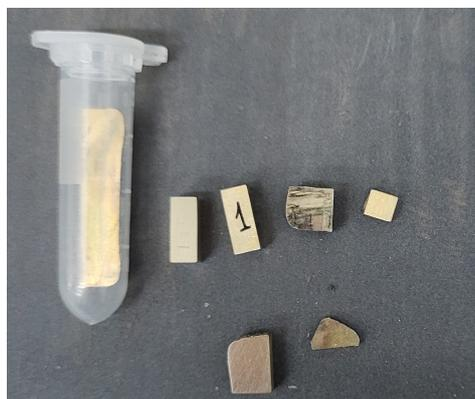
**Figura 13:** diversas piezas de la muestra 78 de  $Cu_{82.8}Al_{13.2}Ni_4 + B_{0.2}Zr_{0.1}$  para las pruebas de compresión, microscopía óptica y DSC.
