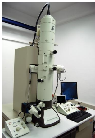
FIGURA 3.1. Imagen de referencia equipo TEM modelo JEOL JEM1011. Ubicado en IDIVAL. Adaptada de [32].
