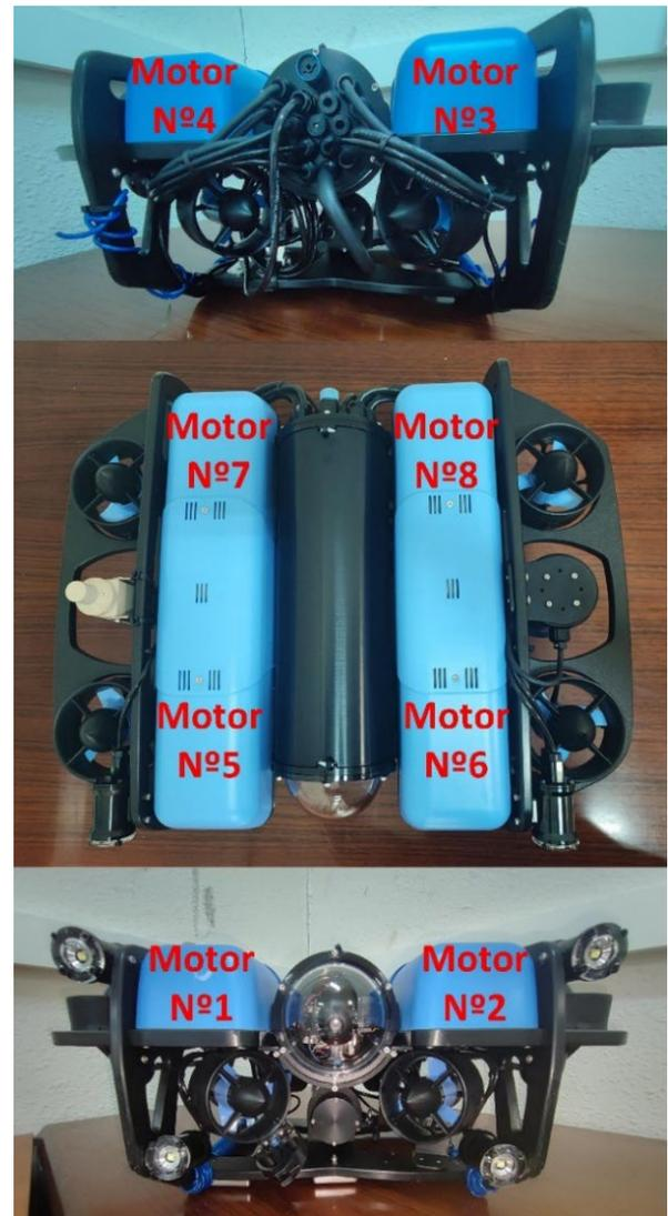
Figura 23. Disposición de los propulsores en el ROV
