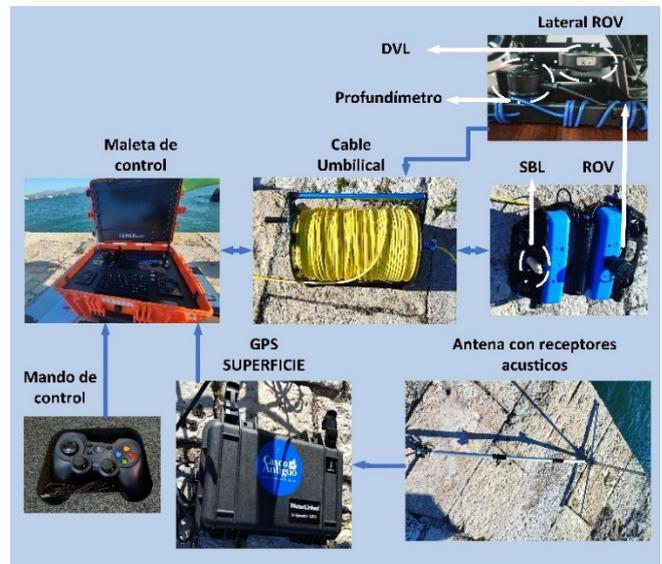
Figura 11: Esquema de conexiones de los equipos.
