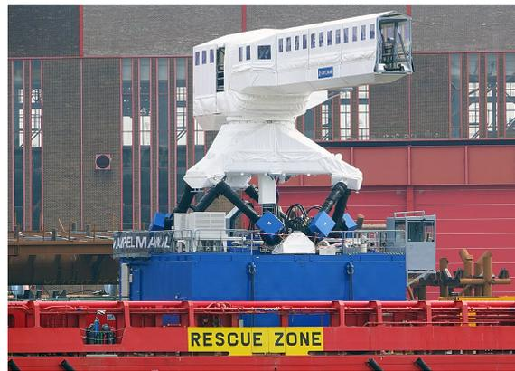
Figura 1.1: Sistema Ampelmann de estabilización que usa una plataforma de Stewart (los brazos se pueden identificar, en negro). Imagen por Kees Torn.
