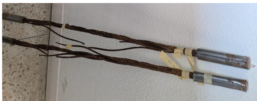
b) Probetas elaboradas en base a los cordones recibidos, una vez ensayadas a tracción
