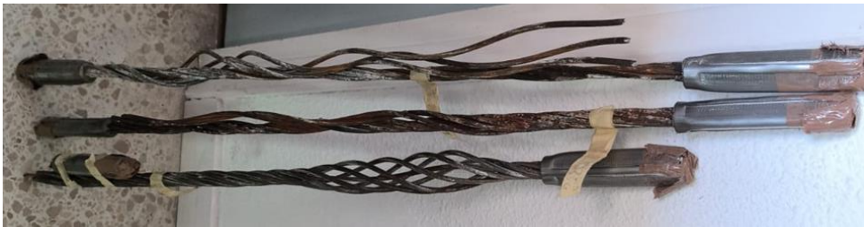
b) Probetas elaboradas en base a los cordones recibidos, una vez ensayadas a tracción
