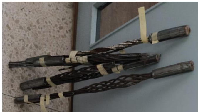
b) Probetas elaboradas en base a los cordones recibidos, una vez ensayadas a tracción
