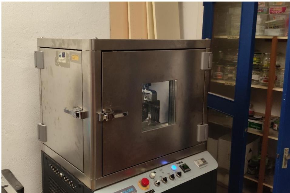
*81 Máquina para ensayo de módulos dinámicos.*
