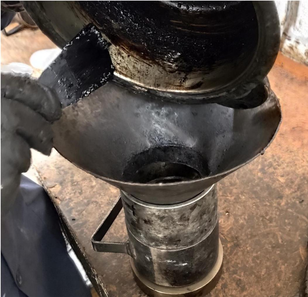
*41 Vertido de la mezcla a molde de probetas Marshall.*
