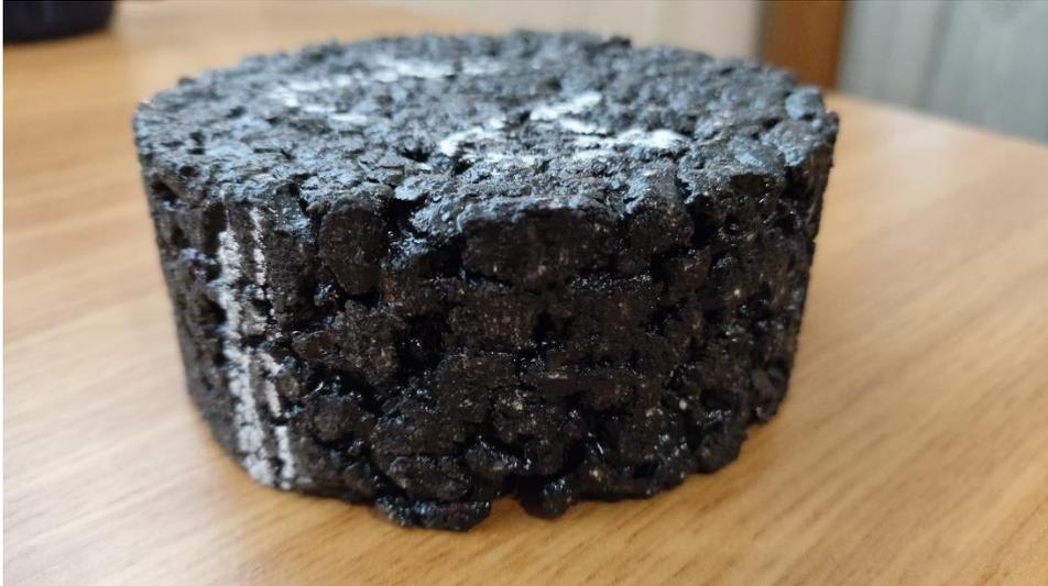
*6 Probeta de mezcla AUTL obtenida en laboratorio*
