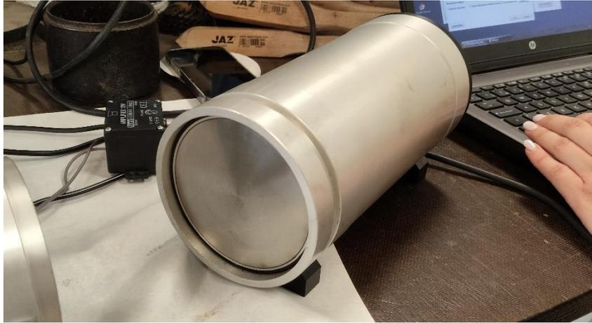
*76 Pistón del tubo para ajuste de la probeta*
