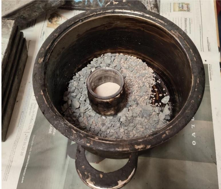
33 Áridos y filler de la mezcla, tras sacarlos del horno de precalentamiento.
