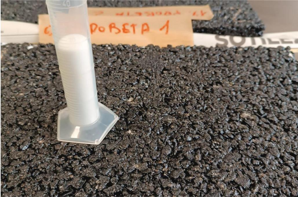
*63 Arena dosificada para ensayo de círculo de arena.*
