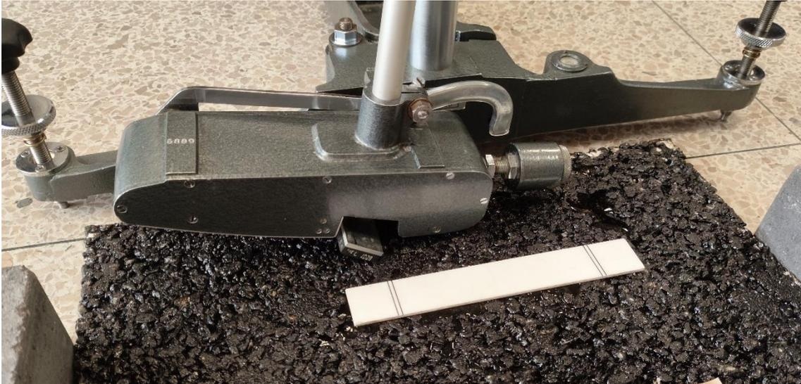
*58 Final del contacto zapata-probeta*
