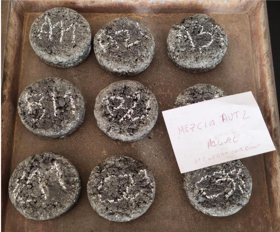
*96 Probetas con 1% de N.C. tras ser ensayadas en el ensayo Cántabro*
