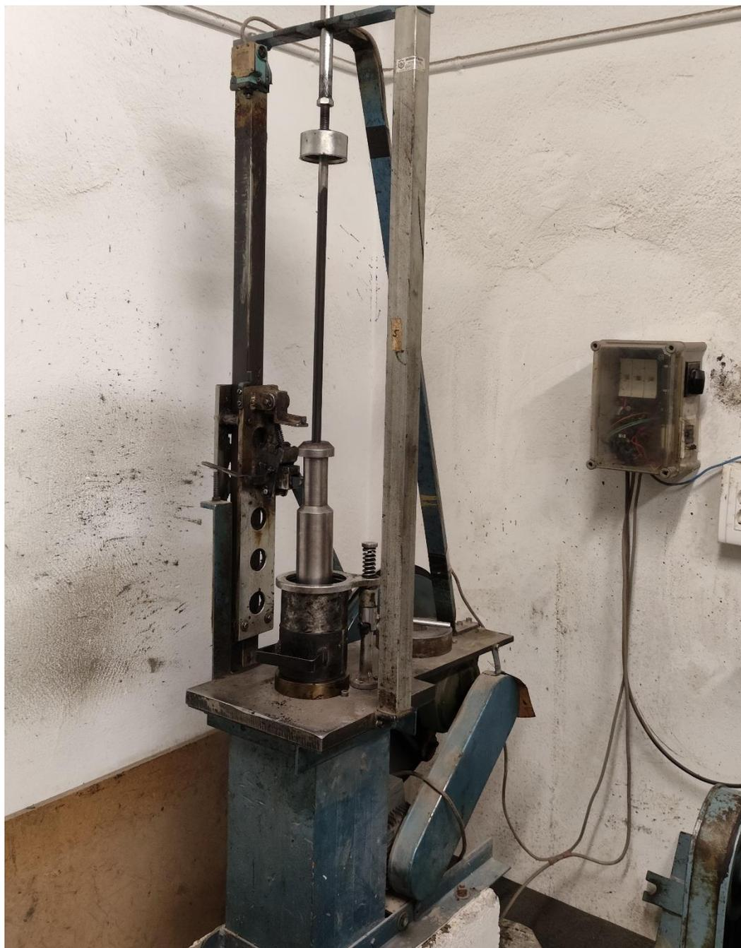
*42 Molde con mezcla, colocado en compactadora Marshall.*
