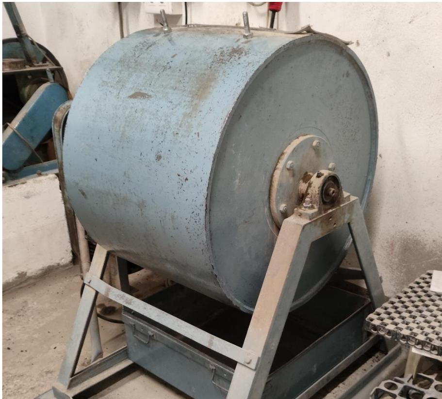
*52 Tambor el ensayo de Los Ángeles, utilizado en este ensayo*
