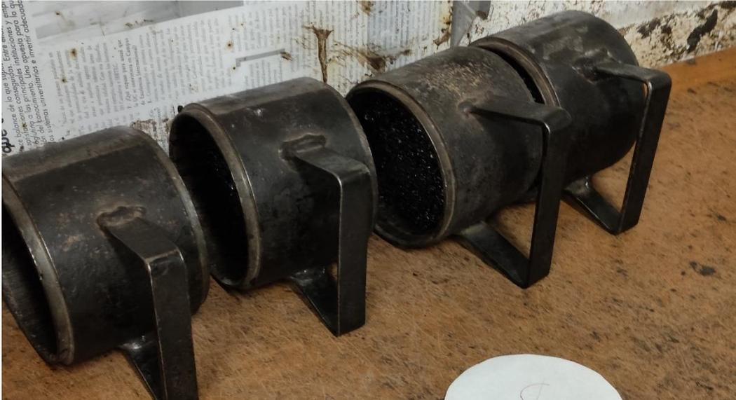
*43 Probetas a la espera de ser desmoldadas.*
