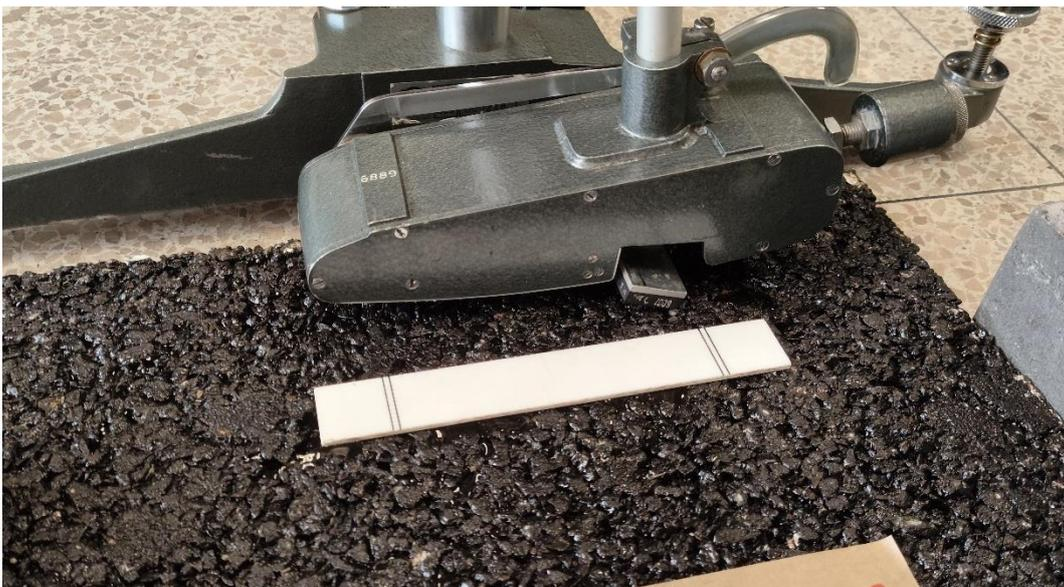
*57 Comienzo del contacto zapata-probeta*
