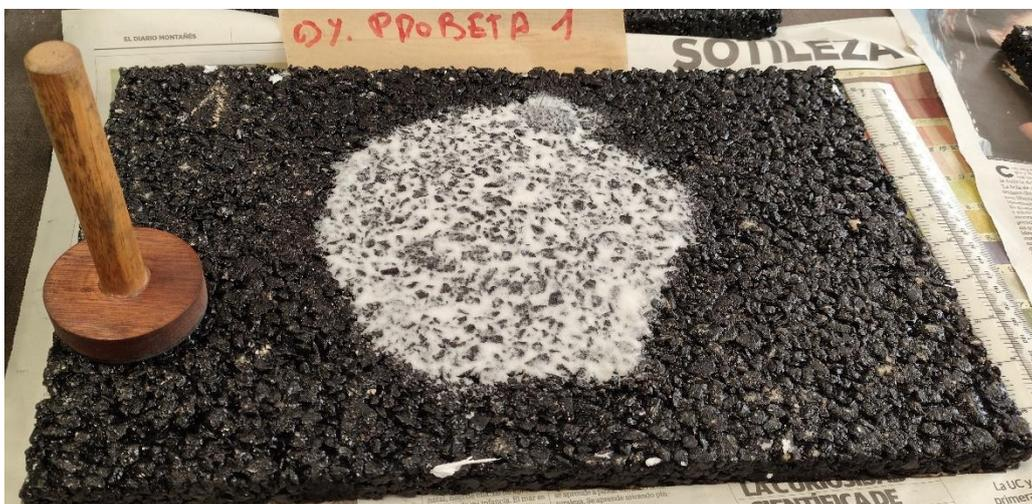
*66 extensión finalizada para ensayo de círculo de arena.*
