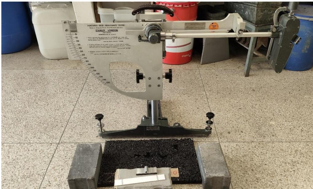
*59 Posición inicial del péndulo para el ensayo*
