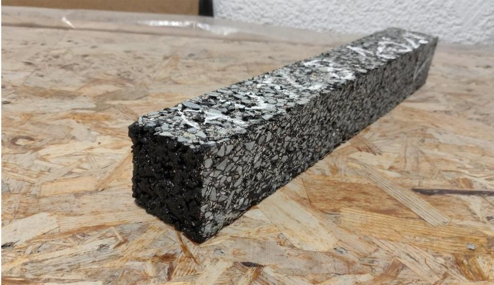
*80 Probeta prismática serrada, para ensayo de módulo dinámico*
