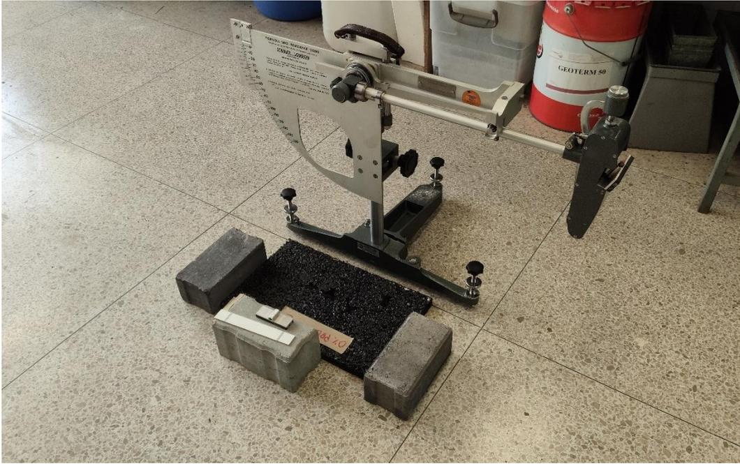
*56 Péndulo TRL para ensayo de coeficiente de resistencia al deslizamiento*
