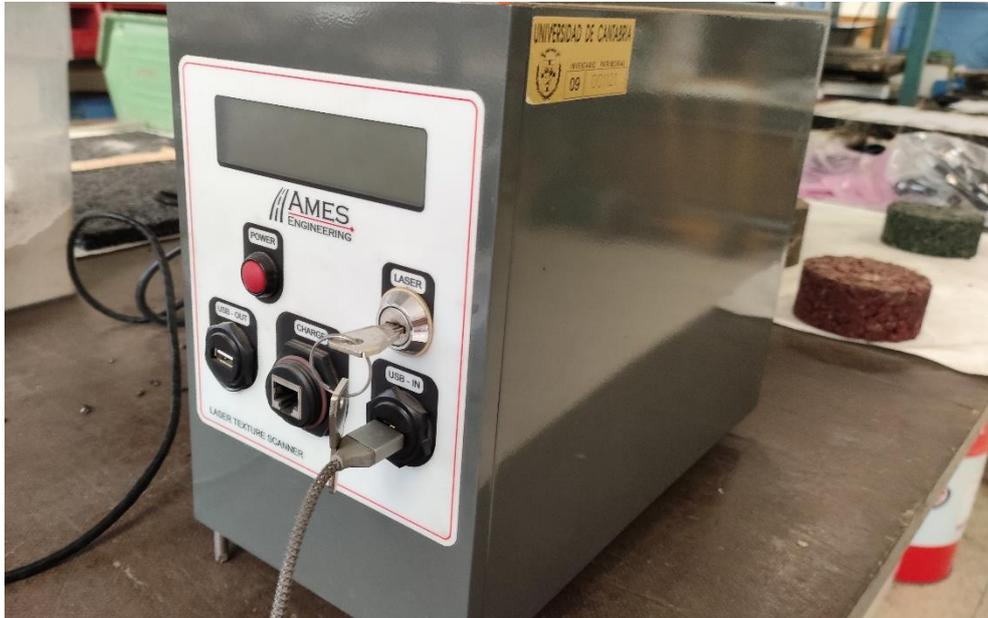
*69 Escáner láser utilizado para el ensayo.*
