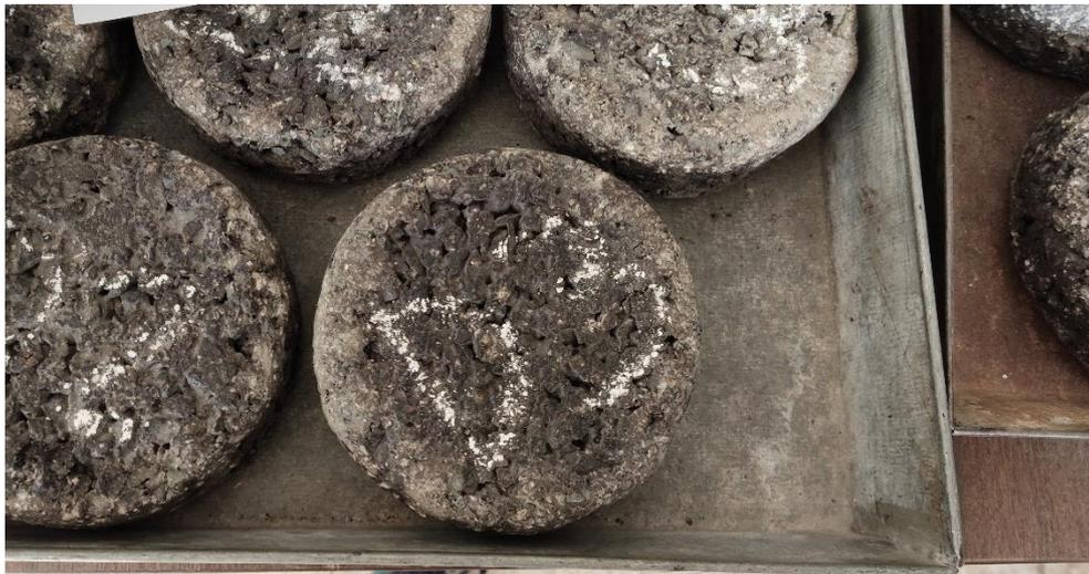
*94 Probetas con 0% de N.C. tras ser ensayadas en el ensayo Cántabro*
