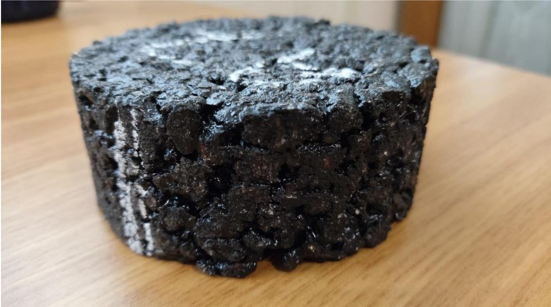
*32 Probeta tipo Marshall utilizada en ensayos*
