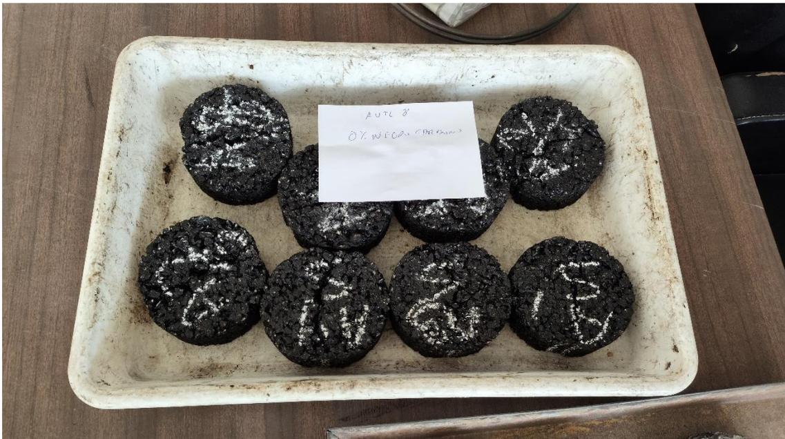
51 Probetas sometidas a ensayo de sensibilidad al agua
