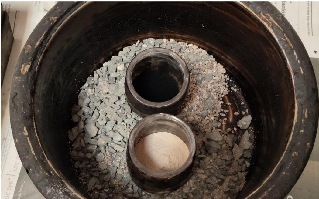
34 Materiales dosificados y precalentados para mezcla con N.C.
