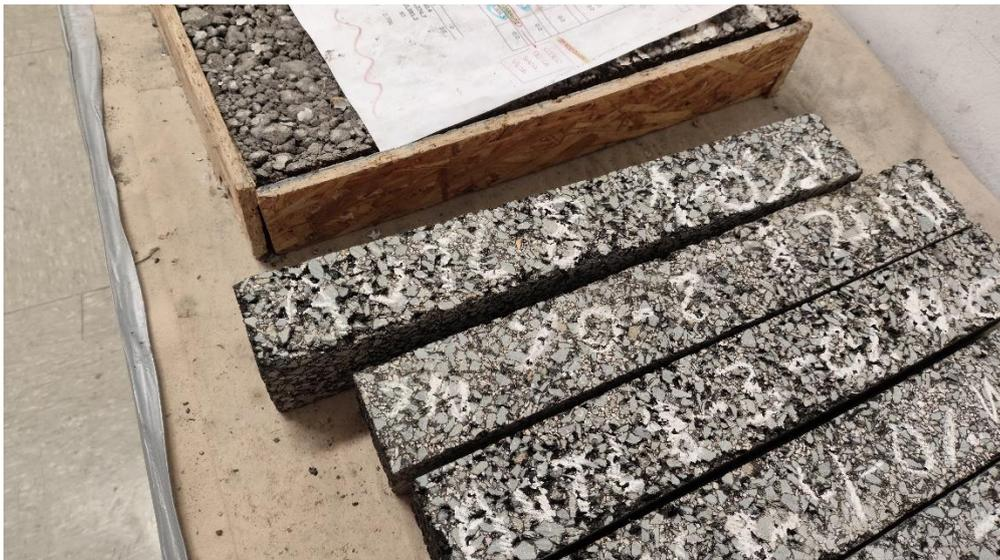
79 Probetas serradas para someter a ensayo de módulo dinámico
