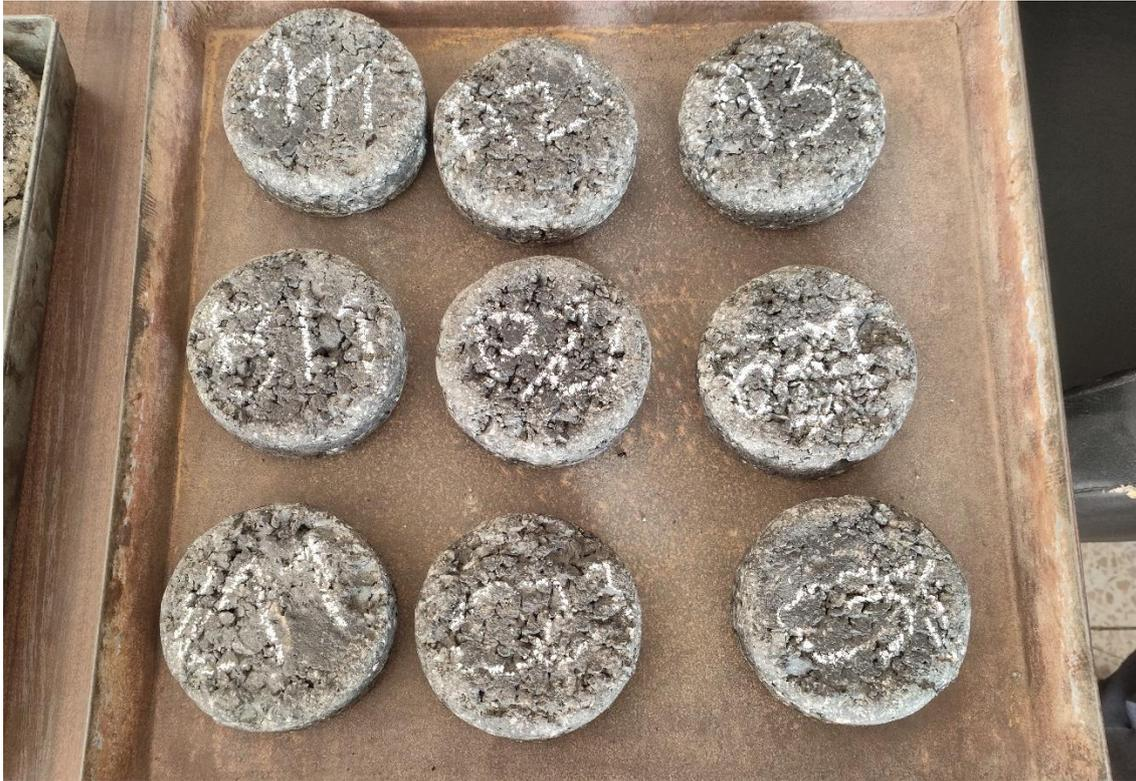
*55 Probetas tipo Marshall tras someterse a ensayo Cántabro*
