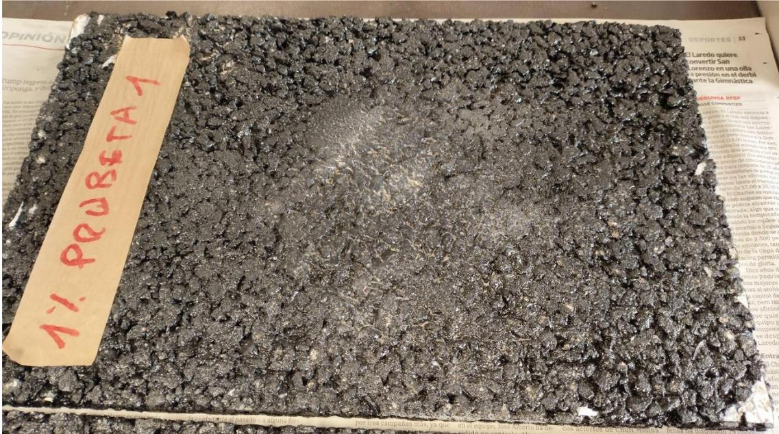
70 Probeta manchada con filler en su zona central, lista para el escáner laser.
