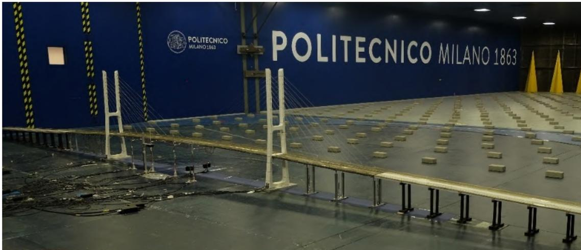
Figura 38. Modelo aeroelástico del Puente Bioceánico [24].
