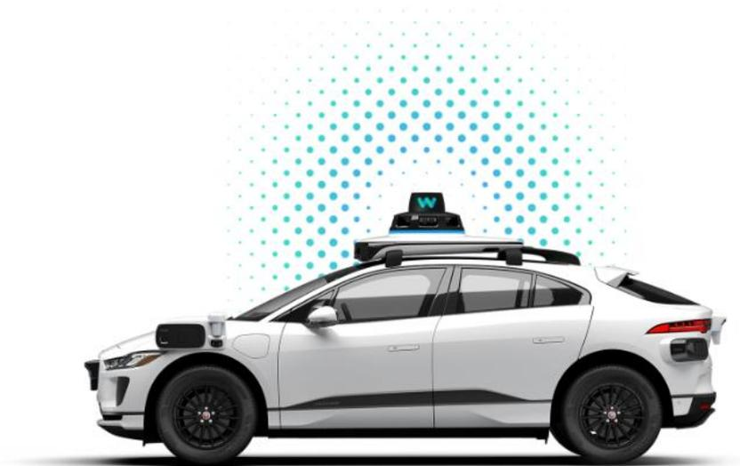
Figura 2. Vehículo autónomo de Waymo (Fuente: [www.waymo.com](http://www.waymo.com)).
