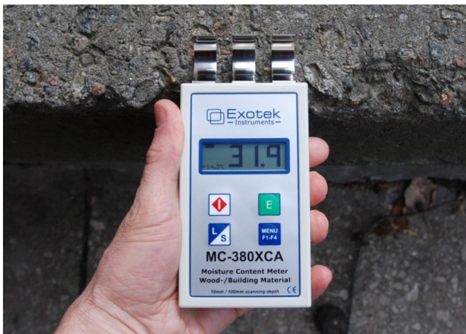
Ilustración 24: Ejemplo del uso del Xilohigrómetro capacitivo (MC-380XCA)
