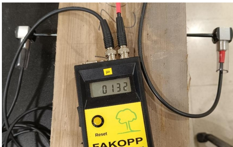
Ilustración 26: Microsecond Timer - Metodología del ensayo directo
