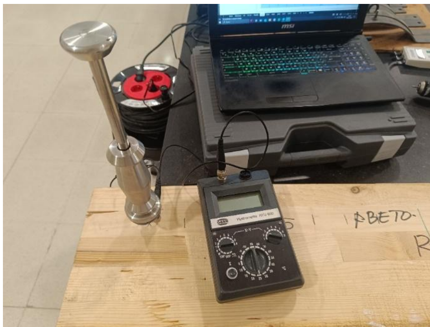
Ilustración 2: Ensayo de medida de la humedad por xilohigrómetro de resistencia eléctrica.
