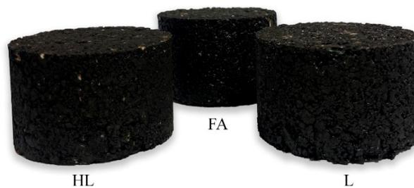
Figura 4.8. Probetas de mezclas bituminosas AC16S
