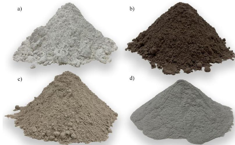
**Figura 4.4.** Filleres de aportación. a) Cal Hidratada HL; b) Cenizas Volantes (FA); Caliza (L); Escoria Blanca de Acero hidratada (LFS<sup>n</sup>)
