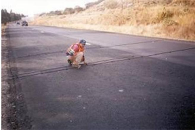
*Figura 4 Manguera neumática.*
