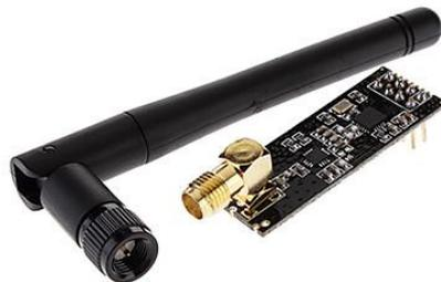
*Figura13 NRF24L01P con antena.*
