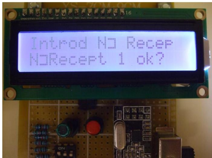
*Figura 96 Mensaje para introducir el número de receptores.*
