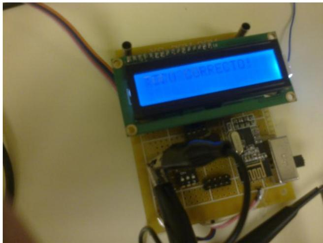
*Figura 80 Dispositivo realizando pruebas de comunicación RF.*
