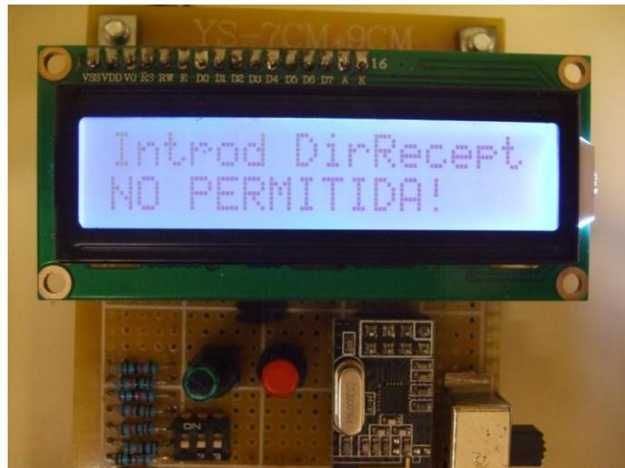
*Figura 99 Mensaje de dirección no permitida.*
