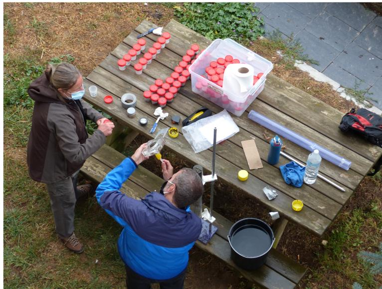
Figura 9: Proceso de división del testigo en muestras de un centímetro.
