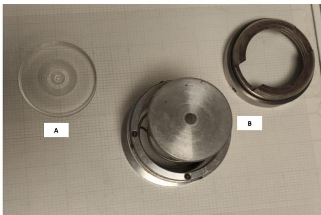
Figura 11: (A) Portamuestras de metacrilato, (B) soporte portamuestras del difractómetro.
