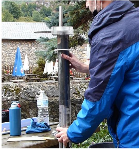
Figura 8: División del testigo en muestras de un centímetro.
