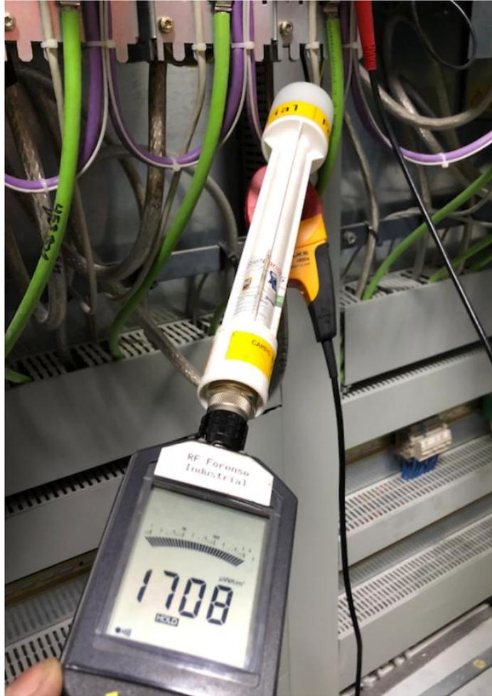
Figura 16. Medida de intensidad del campo eléctrico 1708 mW/cm<sup>2</sup>. [16]
