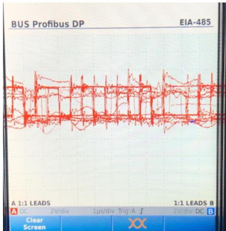
Figura 15. Medida de la calidad de comunicación del bus Profibus DP. [15]
