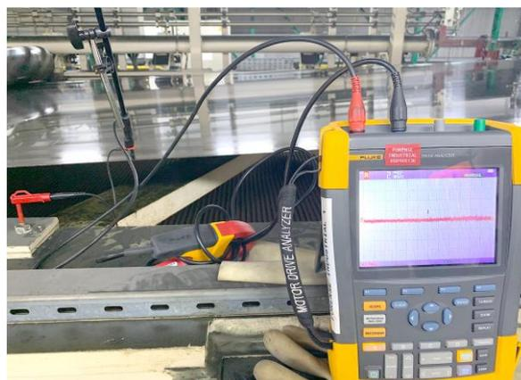
*Figura 20. Medida de la corriente que circula por la máquina herramienta, una correcta protección a tierra minimiza esta corriente. [20]*
