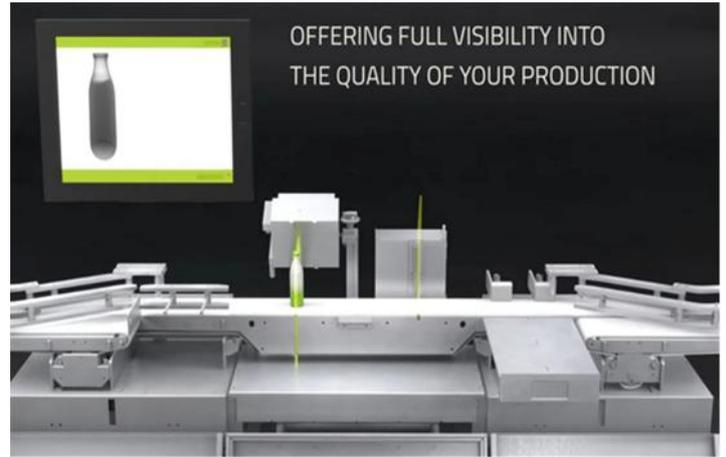
Ilustración 14-Paso por el primer haz de rayos X (perspectiva angular)
