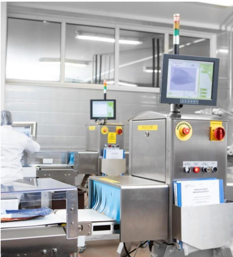
**Ilustración 3-** Equipo Meki integrado a las líneas de producción de La Ermita Delicatessen
