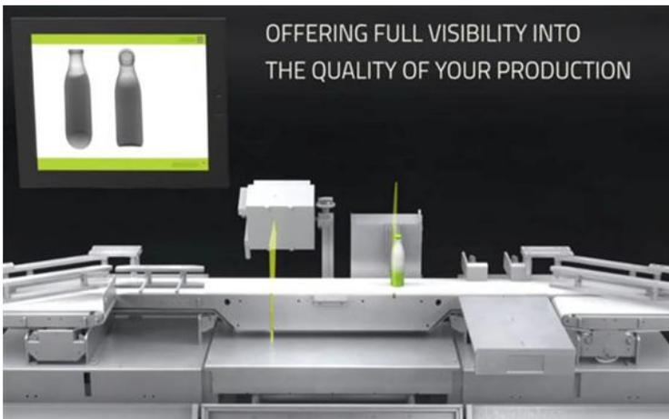
Ilustración 15-Paso por el segundo haz de rayos X (perspectiva lateral)
