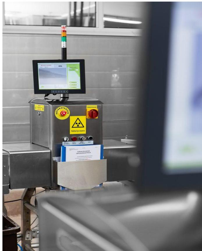
**Ilustración 4-** - Equipo Meki integrado a las líneas de producción de La Ermita Delicatessen
