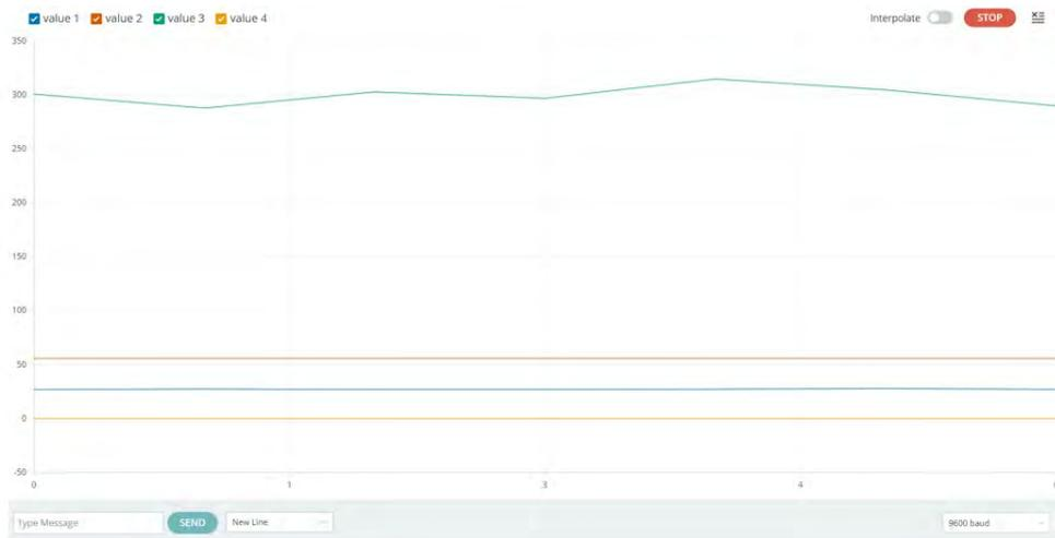
Figura 4.18: Gráfica con las lecturas del DHT11, MQ-2 y estado del ventilador
