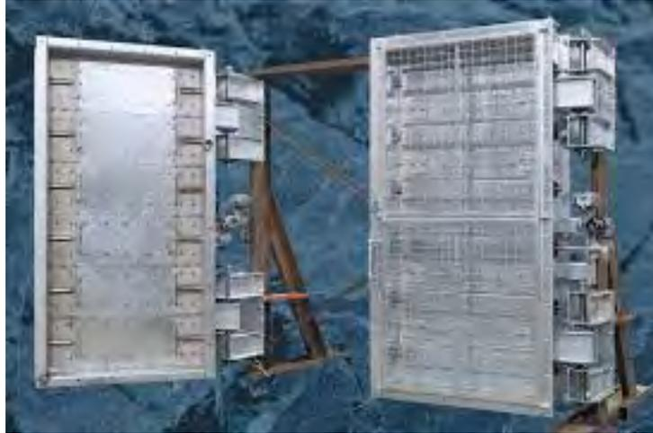
Figura 2.22: Compuerta de ventilación de MDM
