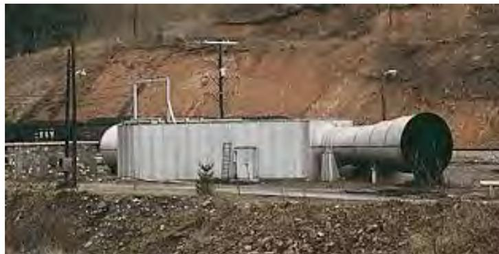
Figura 2.26: Ventilador principal en la boca de un pozo
