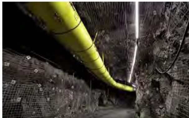
Figura 2.5: Manga flexible con anillos metálicos
