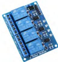
Figura 4.9: Módulo de relés de 4 canales
