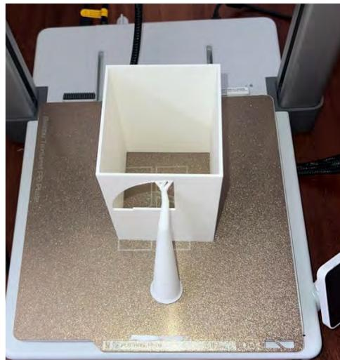
Figura 4.26: Pieza recién impresa con soporte
