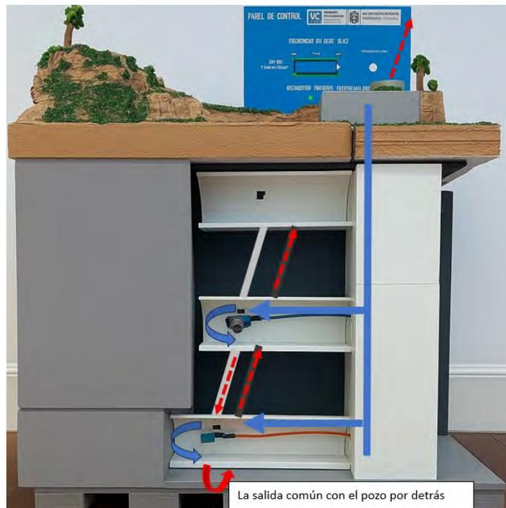
Figura 4.41: Esquema de circulación del aire
