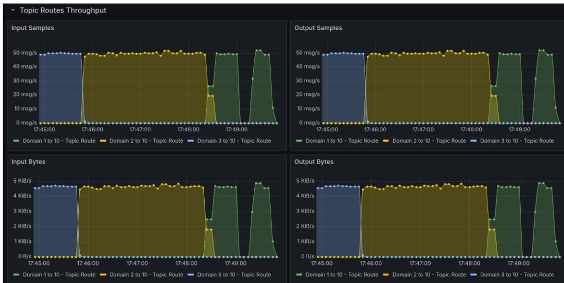
Figura 14: Tasa de mensajes y bytes por segundo entre dominios DDS a nivel de ruta.
