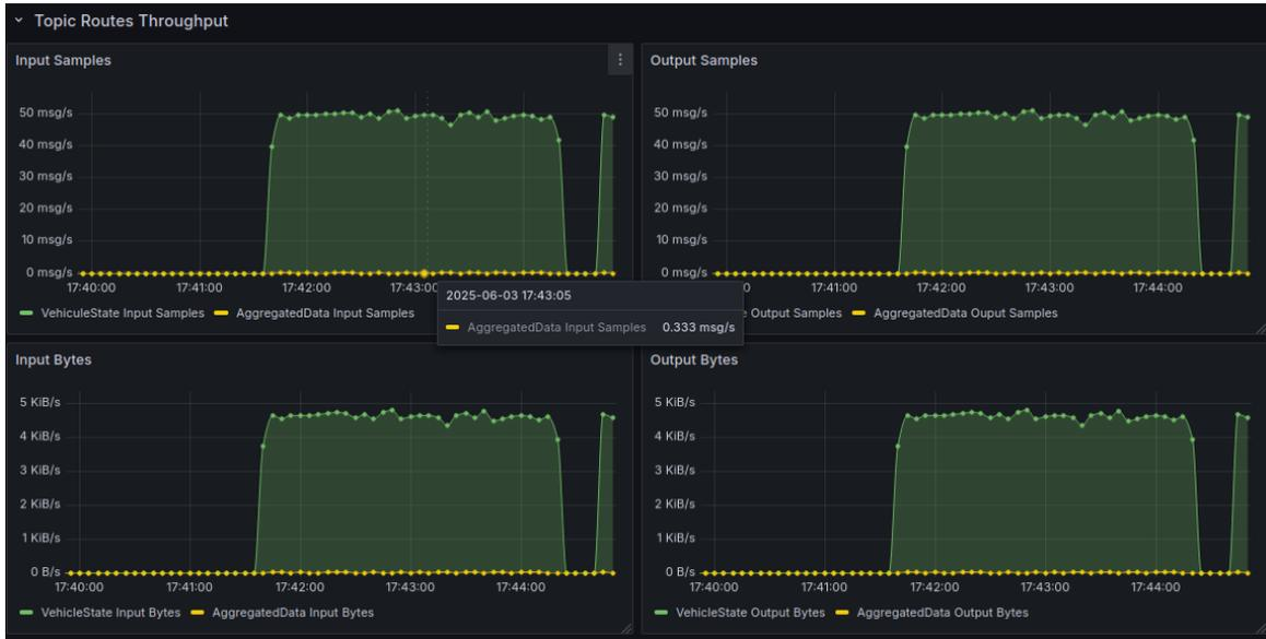
Figura 16: Tasa de mensajes y bytes por segundo entre DDS y Kafka a nivel de ruta.
