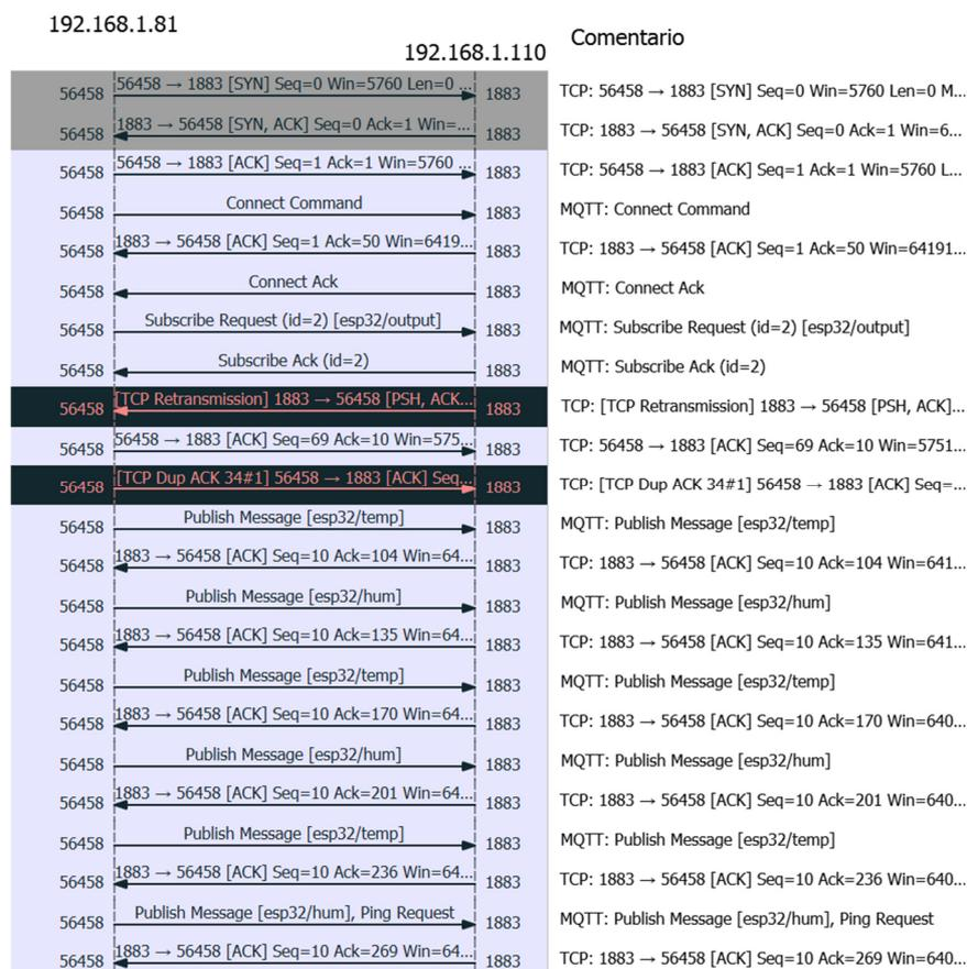
Figura 5.15: Intercambio de mensajes entre el cliente MQTT y el bróker
