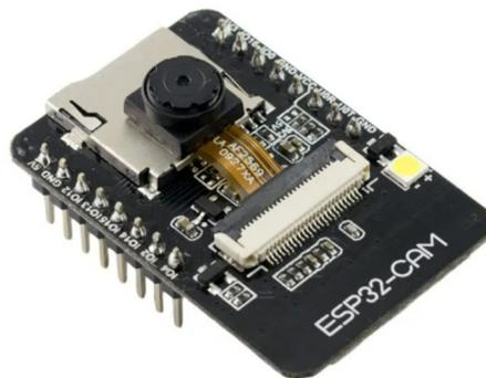
*Figura 4.3: Estructura física del ESP32-CAM*
