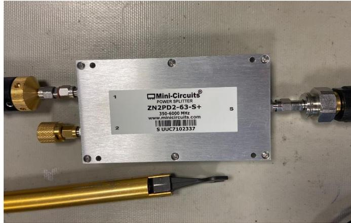
Figura 73. Medida en laboratorio del ZN2PD2-63-S+.
