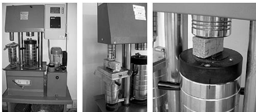
Fig. 2.48 Ensayos de rotura a flexión y compresión ( www.ibertest.es ).
