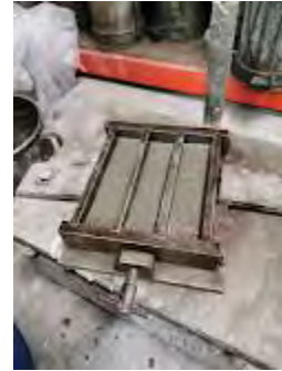
Fig3.39 Molde normalizado. Fig.3.40 Molde al 50% de llenado, con y sin vibración.
