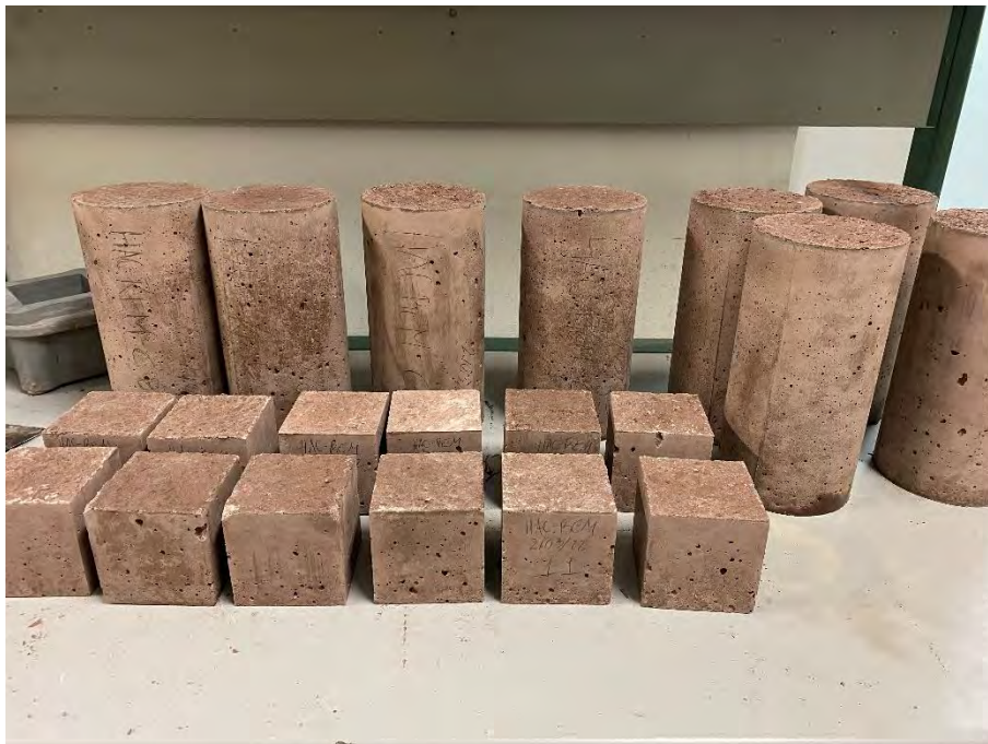
Fig.4.42. Probetas recién moldeadas y desmoldeadas del HAC-R100A.
