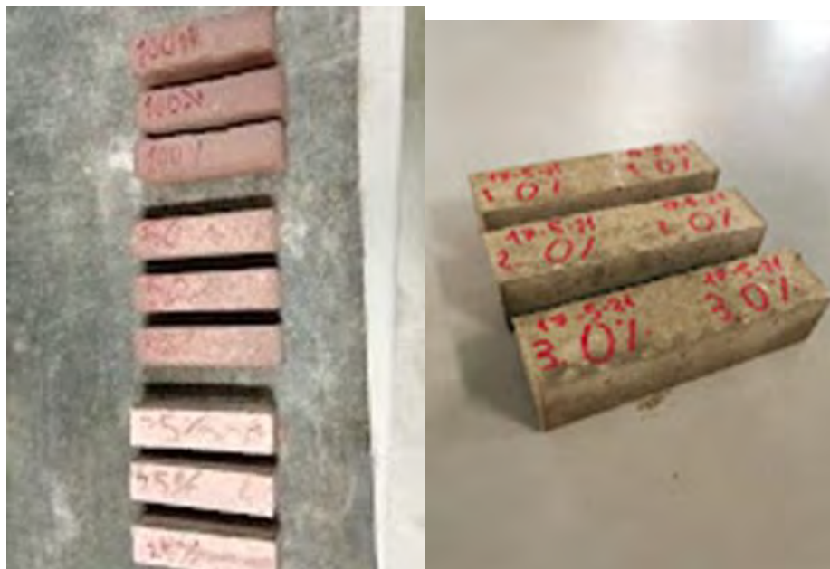
Fig. 3.52 Probetas desmoldeadas 0 % residuo cerámico (derecha) y 25 %; 50 % y 100 % de residuo cerámico (izquierda).
