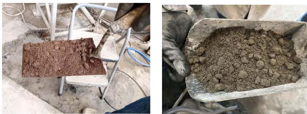
Fig.4.40. Muestra de HAC-R100 (izquierda) y HAC-C (derecha).
