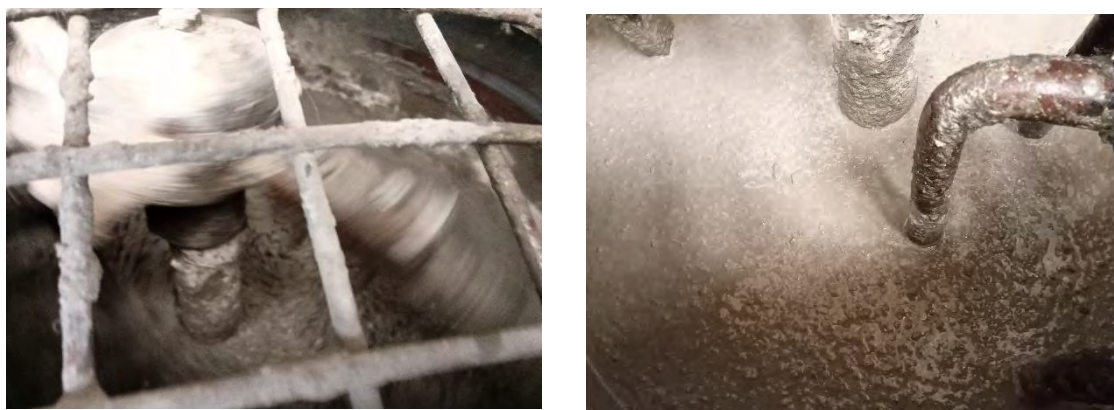
Fig.4.17. Estado del HAC-C una vez amasado en el interior de la hormigonera LADICIM.
