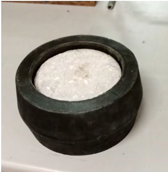
Fig.4.66. Cierre hermético con gato hidráulico. LADICIM.
