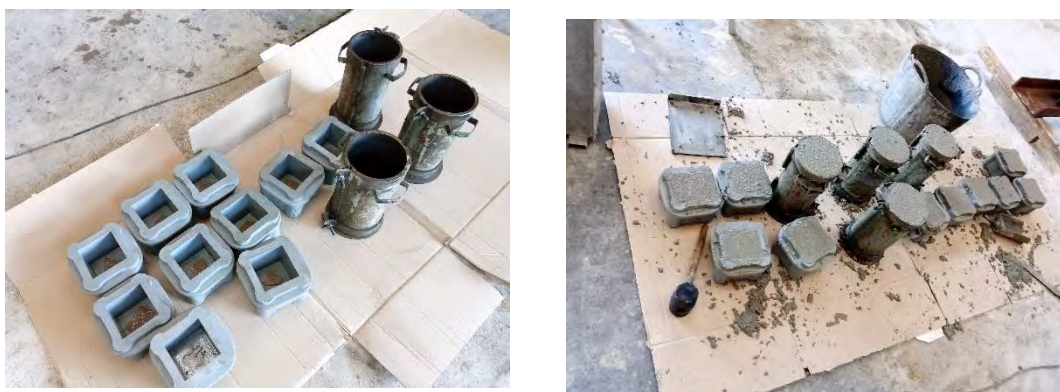
Fig. 4.33. Operaciones de moldeo HAC-C. LADICIM.
