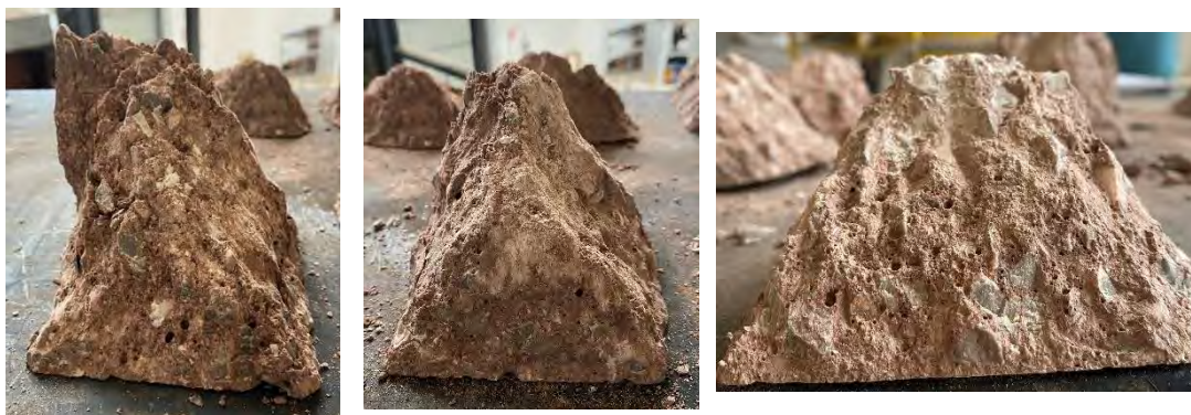
Fig.4.48. Detalle de la rotura a compresión de las probetas HAC-R100 A1 (izquierda) HAC-R100 A2 (centro) y HAC-R100 A3 (derecha) a los 7 días de edad.
