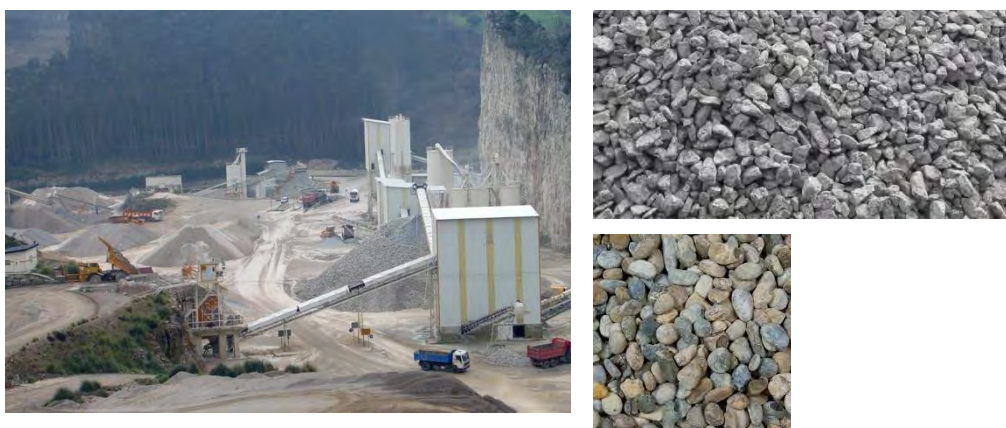
Fig. 2.68 Cantera de Hormisa, áridos de machaqueo y de cantos rodados.
