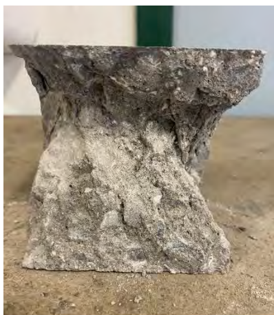
Fig. 4.35. Probeta de HAC-C 22/2/22-1 sometida a ensayo de compresión a los 7 días de edad.
