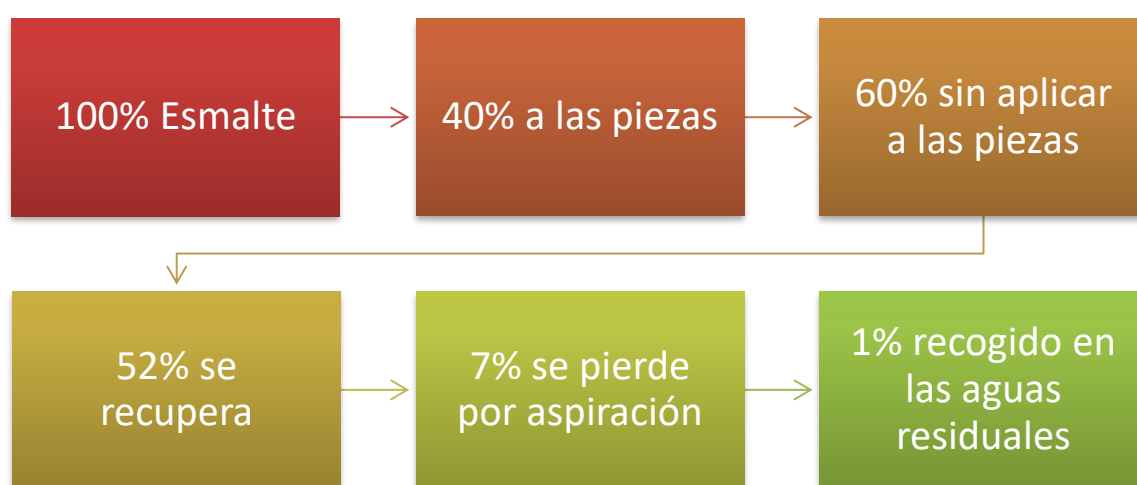
Fig. 2.14. Distribución de pérdidas de esmalte en la aplicación por proyección.
