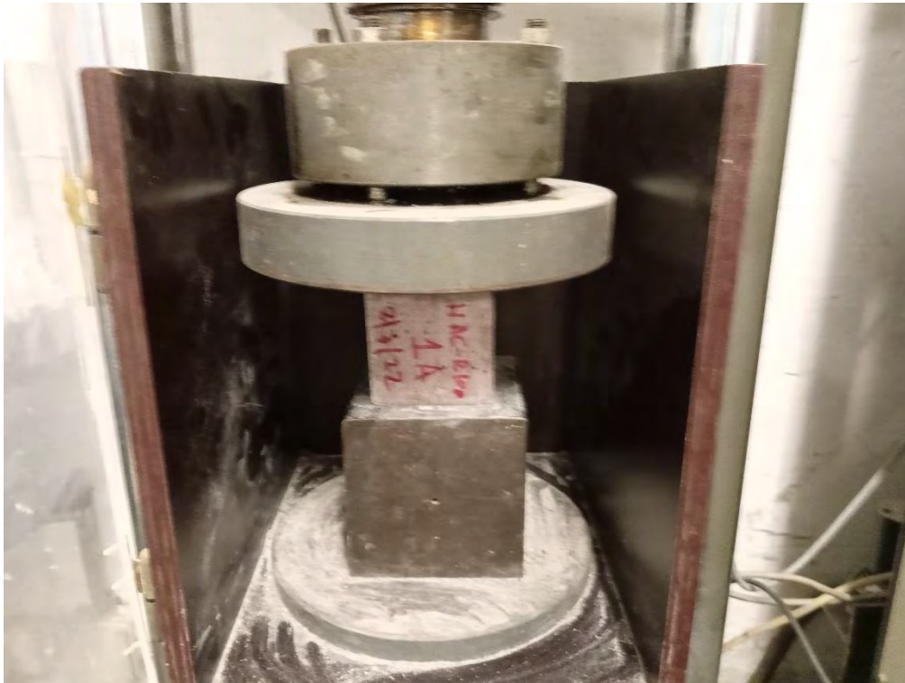
Fig. 4.46. Probeta HAC-R100 A1 colocada en prensa servohidraulica para ensayo de rotura a compresión.
