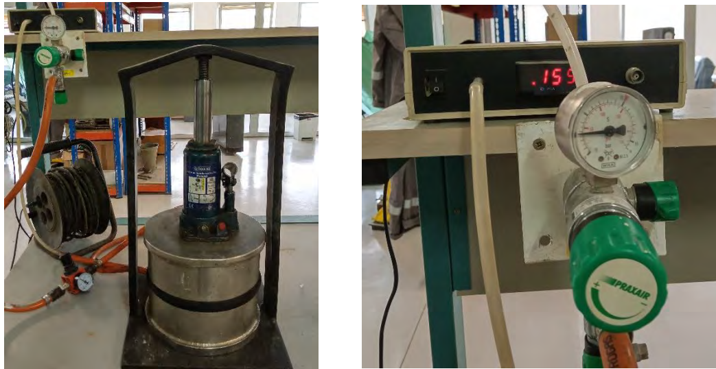
Fig.4.67. Aparato de ensayo montado y caudalímetro. LADICIM.
