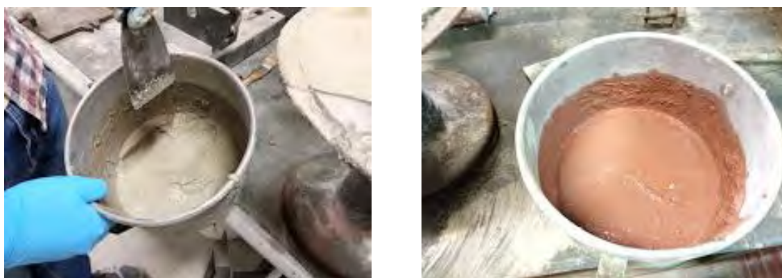
Fig. 3.49. Amasado con 0 % de residuo cerámico (izquierda) y con 100 % de residuo cerámico (derecha).
