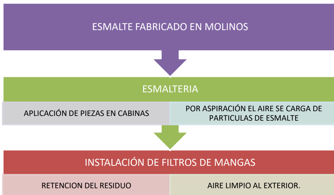
Fig. 3.5 Esquema de recogida de residuo procedente de la aplicación en esmaltería.
