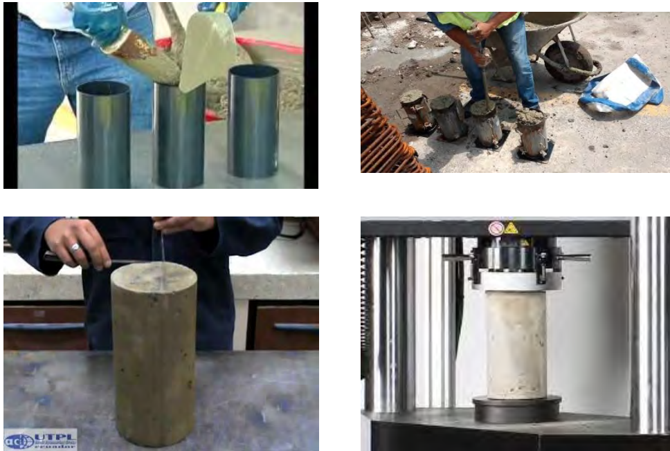
Fig. 2.74 Ensayo de resistencia a compresión ( www.ibertest.es ).
