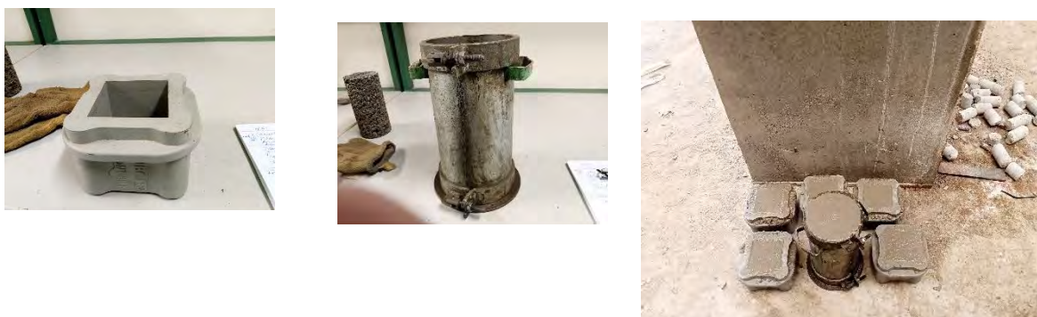
Fig.3.70. Moldes cubico y cilíndrico y probetas hormigón en estado fresco. LADICIM.
