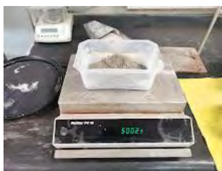
Fig.3.34 Pesado de agua (250 g) y arena de sílice de grano 2 mm (1500 g).
