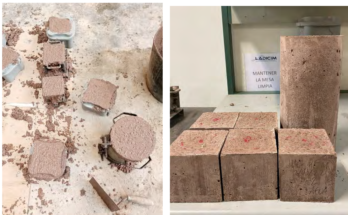
Fig. 4.44. HAC-R100B recién moldeado (izquierda) y desmoldeado a las 24 h (derecha).
