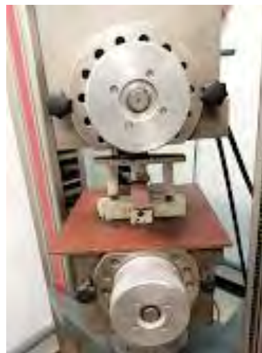
Fig.3.43 Prensa con probeta y útil de ensayo
