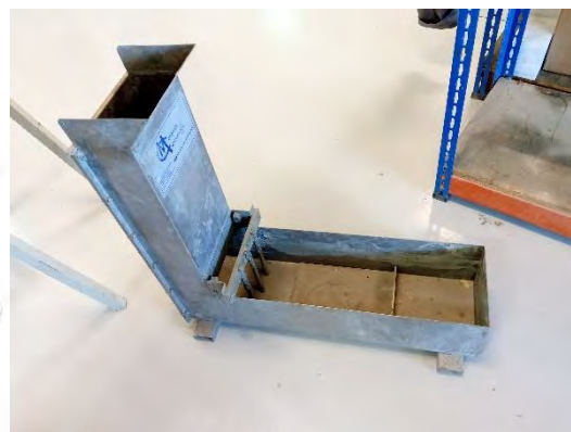
Fig.3.66. Dimensiones y útil físico de caja en “L” existente en LADICIM.
