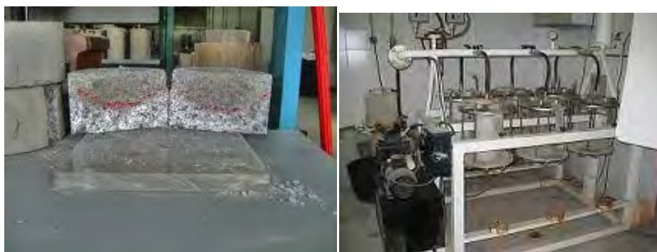
Fig. 2.73 Ensayo de permeabilidad y probetas ensayadas (Thomas, C., 2012).
