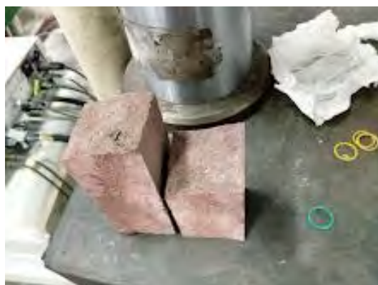
Fig.4.11. Sección de probeta de referencia 25% con impureza vegetal.
