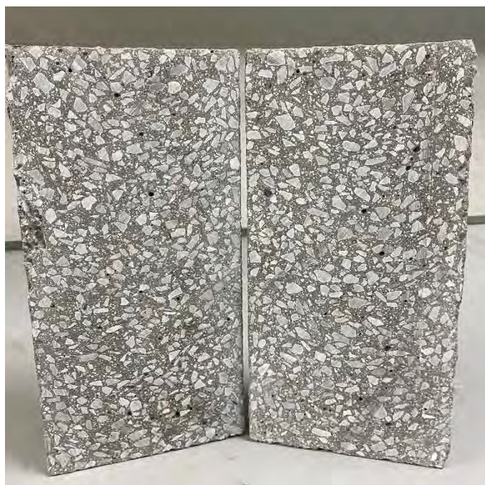
Fig.4.23. Probeta cilíndrica seccionada longitudinalmente HAC-C prueba. LADICIM.
