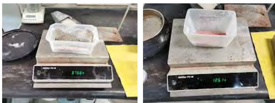
Fig. 3.36 Cemento CEM I 52,5 (375 g) y residuo cerámico (125 g). Muestra ME-25.
