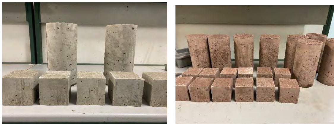
Fig. 4.43. Diferencia de color entre el HAC-C (izquierda) y HAC-R100 A (derecha).
