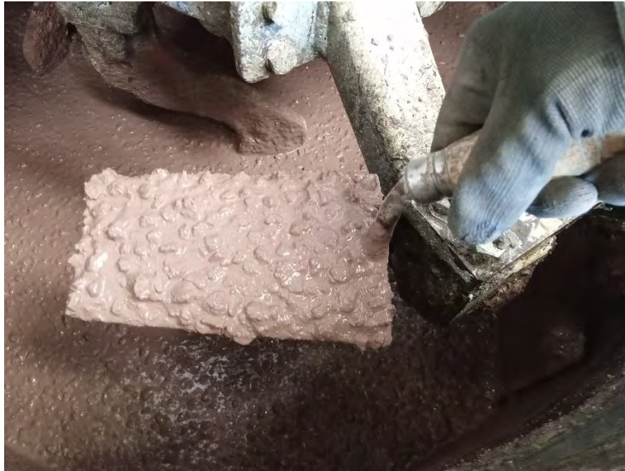
Fig.4.41. Muestra del HAC-R100 con el agua extra añadida.
