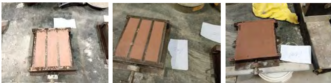
Fig. 3.52 Moldeado de las dosificaciones 25 %; 50 % y 100 % de residuo cerámico.
