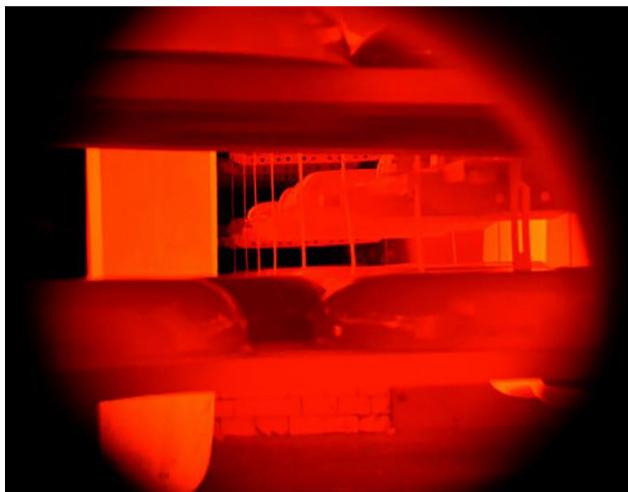
Fig. 2.15. Estado incandescente de las piezas en mufla de vitrificado (Vitrinor).
