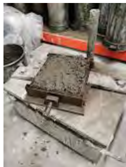
Fig. 3.41. Molde al 100% de llenado, sin y con vibración.
