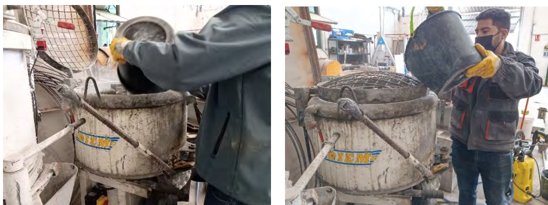
Fig.4.16. Cargado de materiales (izquierda cemento) derecha (agua) LADICIM.
