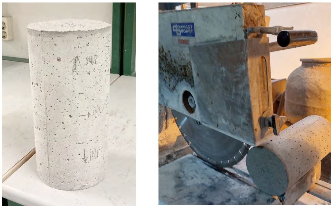
Fig.4.54. Probeta cilíndrica marcada para cortar y máquina de corte LADICIM.
