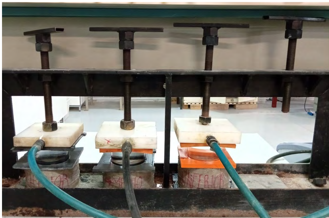
Fig. 4.69. Montaje de las probetas en bancada de ensayo. LADICIM.
