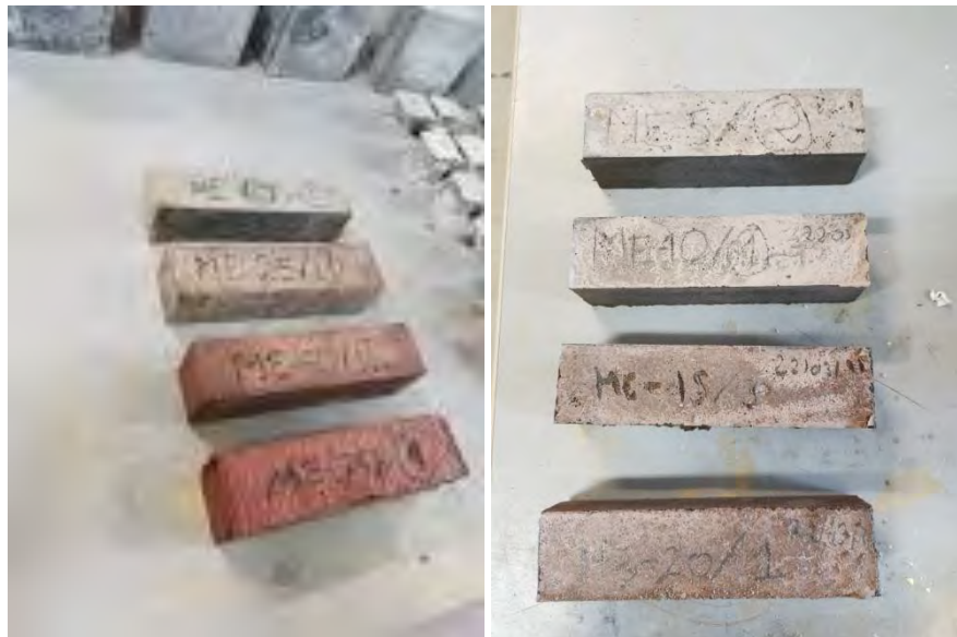
Fig. 4.1 Variación de color de las muestras de mortero en función del % de residuo.
