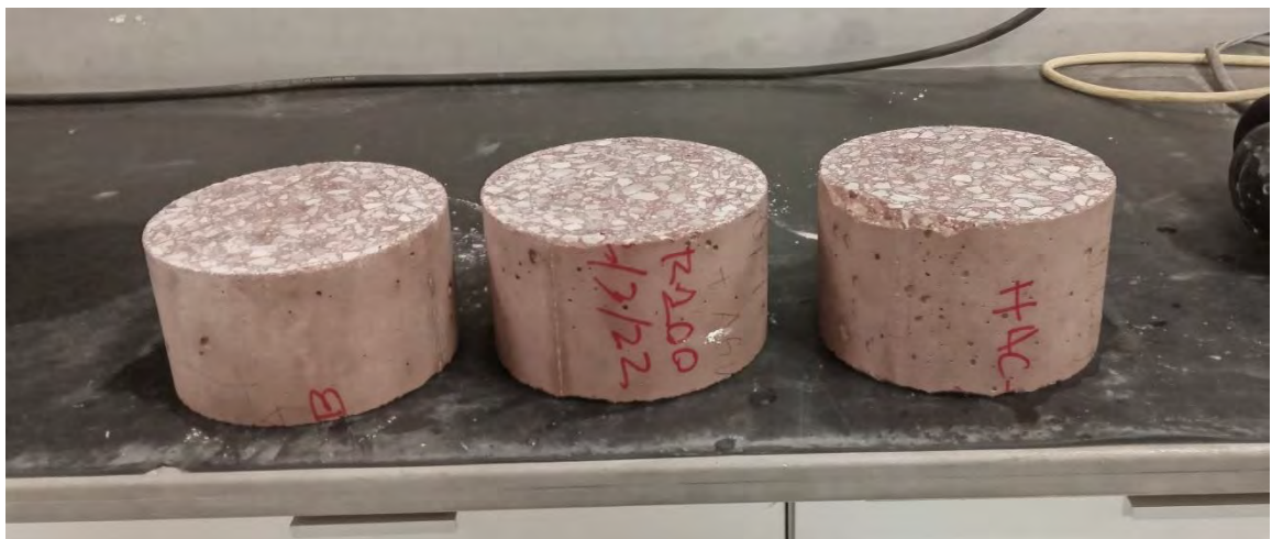
Fig. 4.55. Tercios cortados de HAC-C (imagen superior) HAC-R100A (imagen central) y HAC-R100B (imagen inferior).
