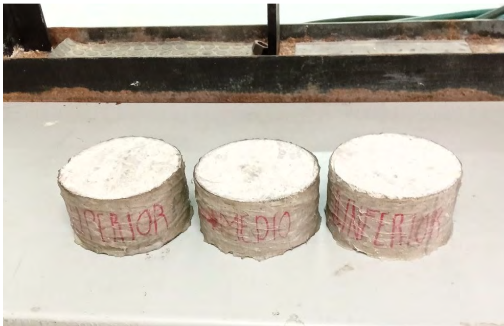
Fig.4.64. Tercios superior, medio e inferior de probeta cilíndrica HAC-C, recubiertos con silicona.
