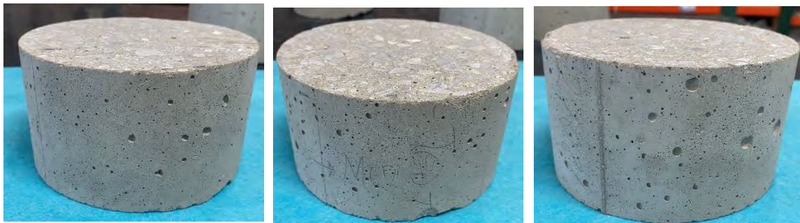
Fig.4.58. Probetas secas de HAC-C. Tercio superior (izquierda de la imagen); tercio medio (centro de la imagen) y tercio inferior (derecha de la imagen).
