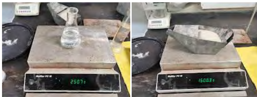
Fig.3.34 Pesado de agua (250 g) y arena de sílice de grano 2 mm (1500 g).
