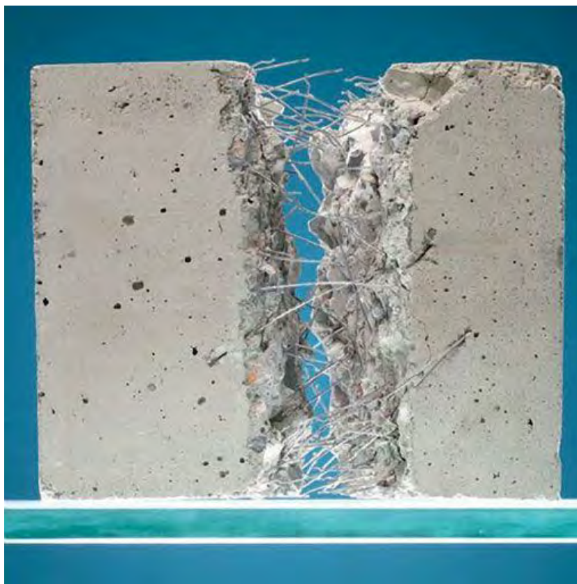
Fig. 2.64 Hormigón reforzado con fibras metálicas. ( http://fernando-teg-obrasciviles.blogspot.com/p/concretos.html ).
