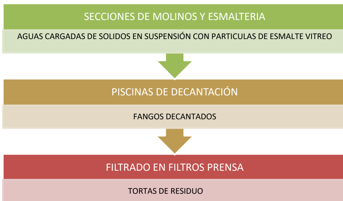
Figura 3.1 Esquema de aguas residuales cargadas de partículas de esmalte.
