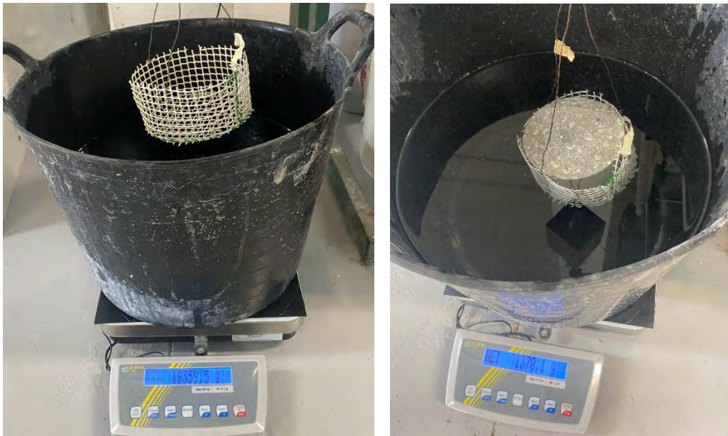
Fig.4.57. Medición del Volumen aparente del tercio medio del HAC-C.
