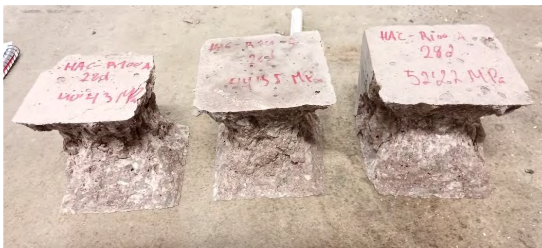
Fig.4.51. Resultados de ensayos de referencias HAC-R100A 6 (izquierda) y HAC-R100B 3 (derecha).
