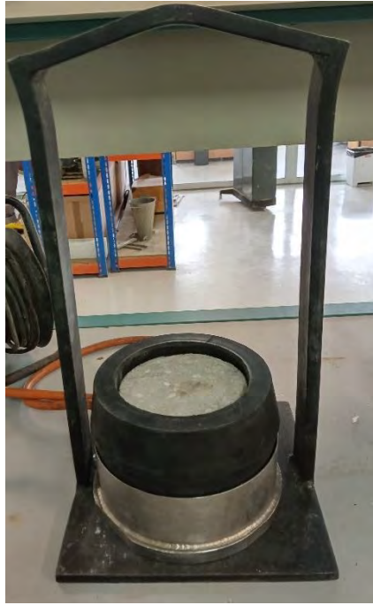
Fig. 4.65. Colocación de junta de caucho terció y colocación del conjunto en aparato de ensayo. LADICIM.
