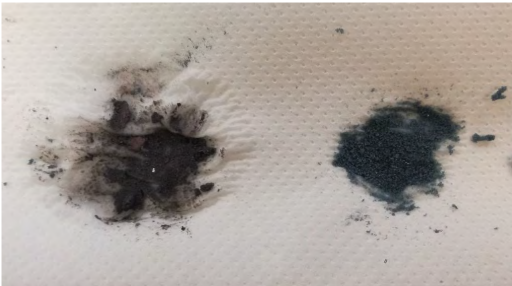
Fig.3.32 Fritura en residuo polvo (izquierda) y en esmalte virgen (derecha).
