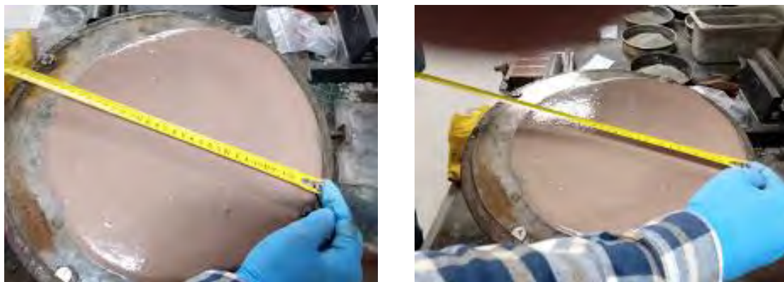
Fig. 3.51 Torta 25 % residuo cerámico 310- 300 mm (izquierda) y de 50 % residuo cerámico 300 – 295 mm (derecha).
