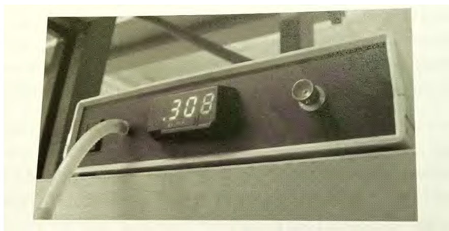
Fig. 3.80. Caudalímetro digital que determina el flujo de oxígeno a la salida de la muestra. ( Patente de invención P201300197).
