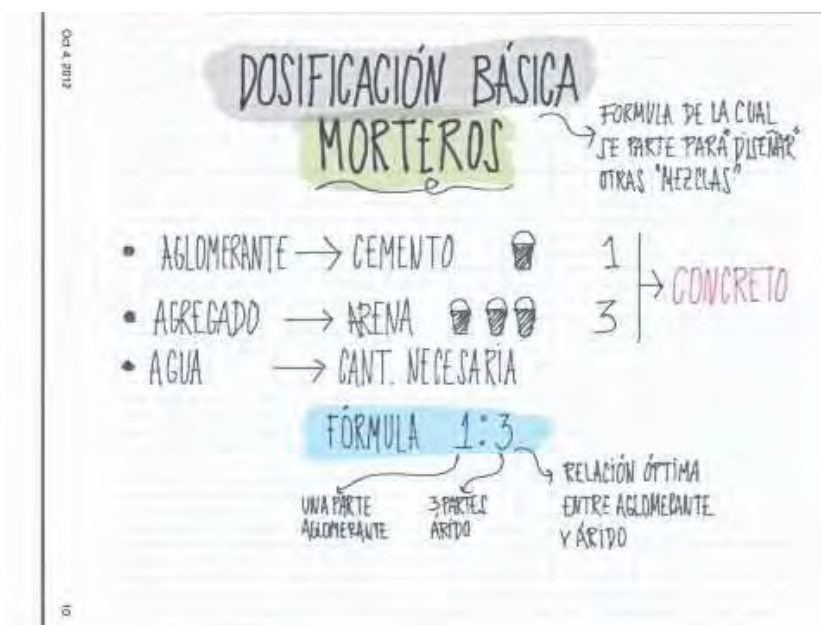
Fig. 2.51 Dosificación básica de un mortero
