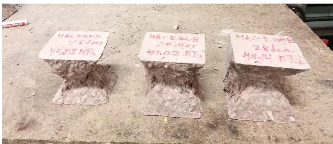
Fig.4.52. Probetas HAC-R100A y HAC-R100B tras el ensayo de rotura a compresión a los 28 días de edad.
