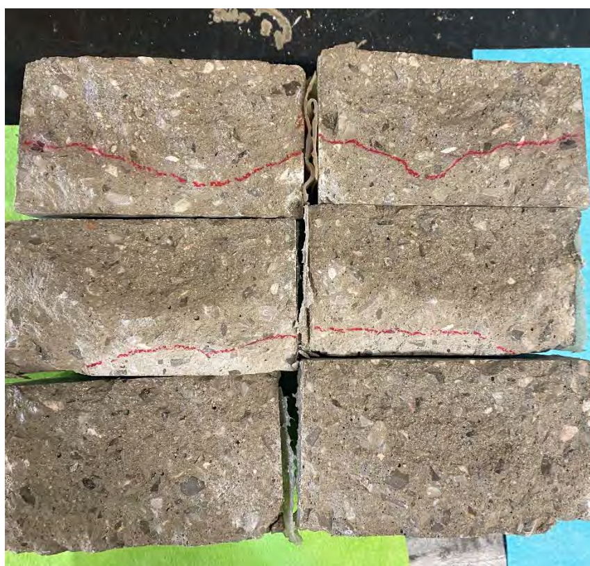
Fig. 4.71. Huellas de penetración máxima en HAC-C.
