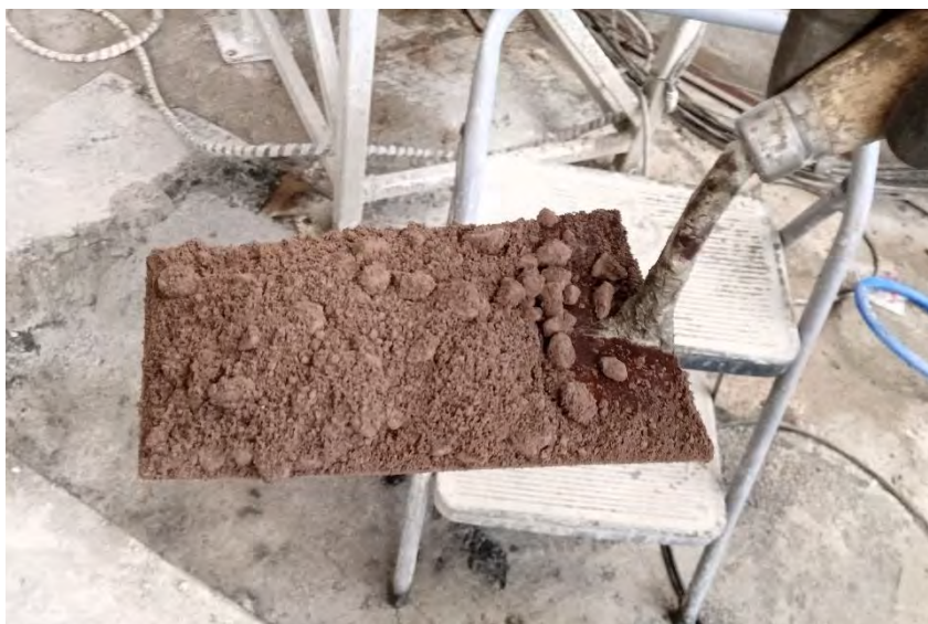
Fig 4.39. Muestra de HAC-R100 con la mitad de agua y 3 minutos de amasado.
