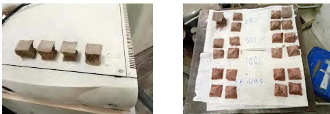
Fig.4.12. Probetas de rotura a compresión a 28 días. 0% (izquierda) y 25, 50 y 100 % (derecha).
