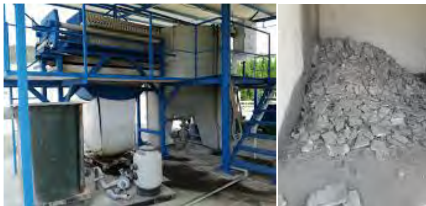
Fig. 2.22. Filtro prensa y residuo en forma de tortas de filtrado (Vitrinor).
