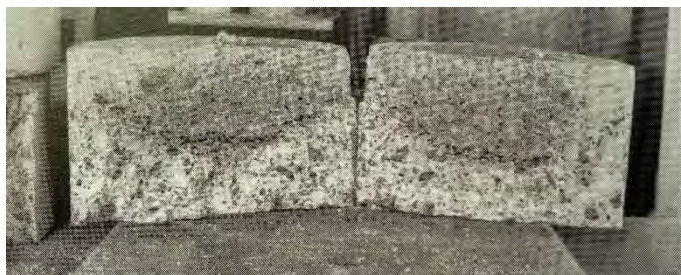
Fig.3.78 Detalle perfil de profundización del agua en los ensayos de penetración de agua bajo presión. (Tesis Doctoral Carlos Thomas García 2012).
