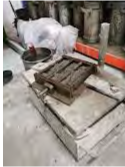
Fig3.39 Molde normalizado. Fig.3.40 Molde al 50% de llenado, con y sin vibración.
