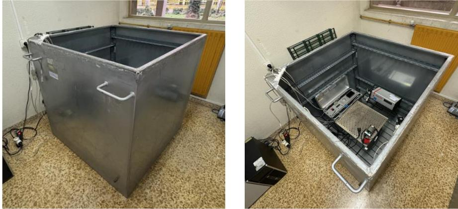
Figura 5. Cámara de radón de LaRUC con la tapa extraída donde se pueden observar los equipos de referencia utilizados en este trabajo.
