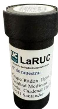
Figura 8. CR-39. Dispositivo utilizado para medir la densidad de trazas.
