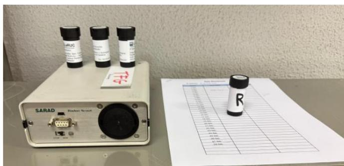
Figura 13. Dispositivo experimental utilizado. Un Radon Scout, 4 CR-39 (3 fijos y 1 móvil) y documento de seguimiento.
